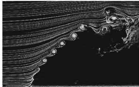
FIGURE 2.11 – Tourbillons de la couche cisailée vus en coupe dans le plan médian xz [54]
