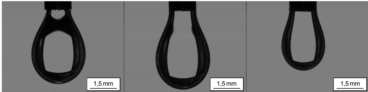
Figure 22 : Photographies de gouttes pendantes obtenues au tensiomètre à goutte pour différents systèmes. De gauche à droite : huile-eau, huile-GA 2,5 % et huile- \beta -lg 2,5 %.
