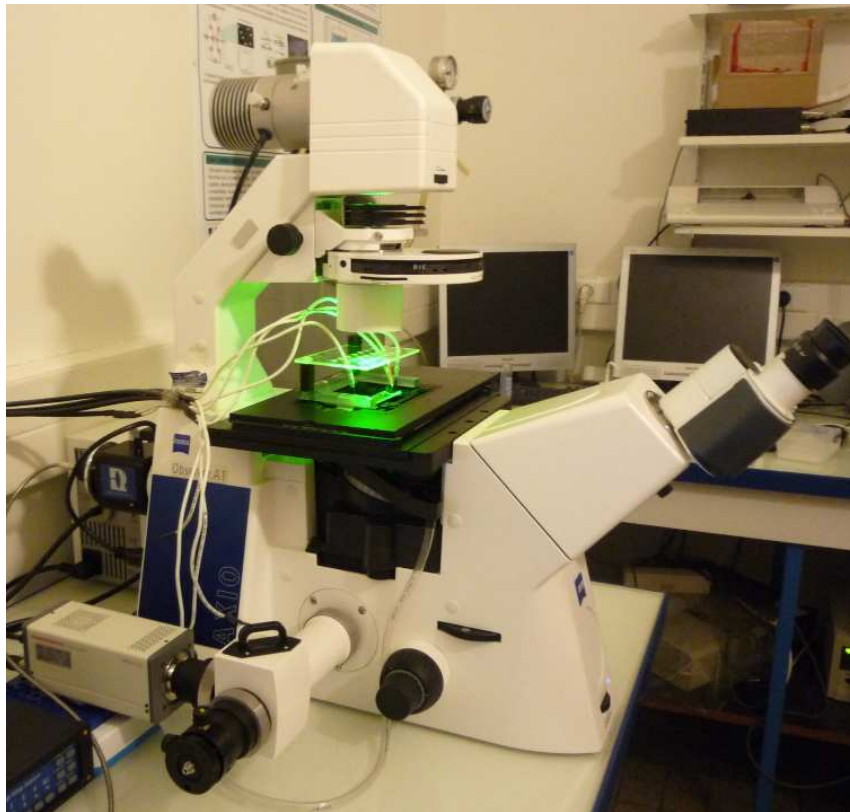
Figure 4.13 – Photographie du poste d'analyse sur puce Avec en bas à gauche le bras dédié à l'analyse quantitative avec la caméra CCD et qualitative avec la sortie fibrée (ici non connectée) et couplée à spectrophotomètre dans l'UV-visible.
