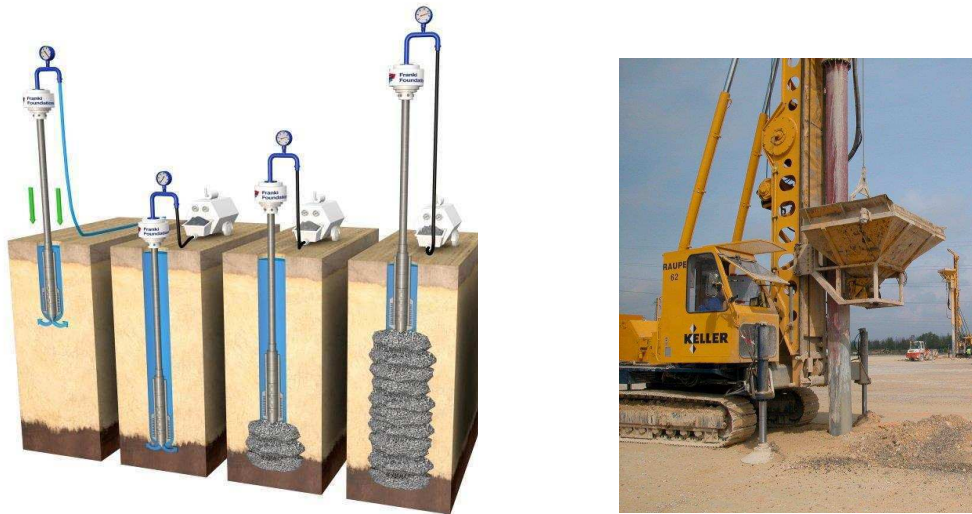
FIGURE 1.1 – Technique de mise en place de colonnes ballastées (sources : sites internet Franki Geotechnics et Keller Group).
