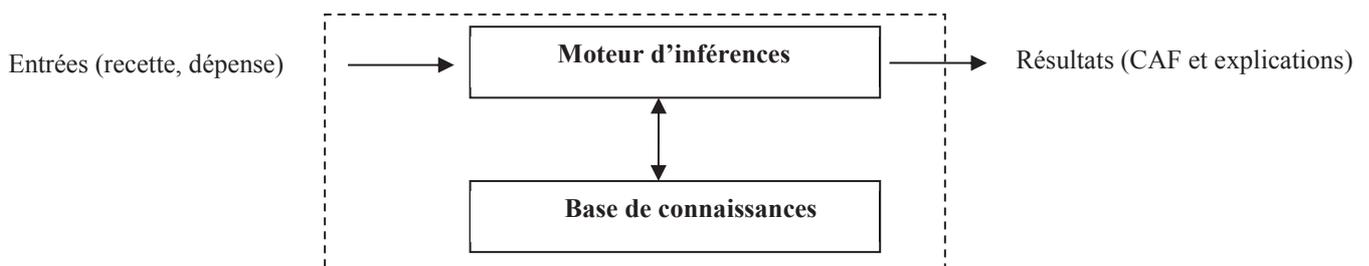
**Figure 1: Structure de base d'un système d'aide à la décision. Des données sont fournies au système et le moteur d'inférences renvoie les résultats et les explications relatives à son raisonnement à partir du contenu de la base de connaissances.**
