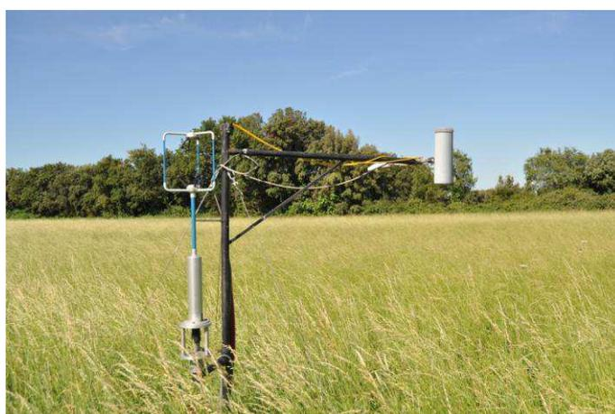
Fig. II.12 Appareil de mesure de l'eddy covariance de l'INRA
