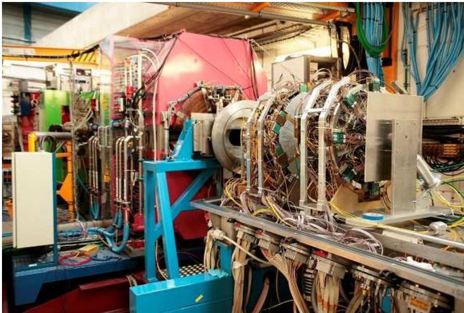
FIGURE 2.19 – Montage expérimental INDRA-VAMOS. En avant-plan nous trouvons le multidétecteur INDRA, alors que le spectromètre VAMOS est visible en arrière-plan.
