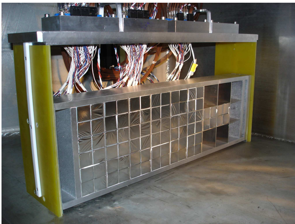
FIGURE 2.14 – Photo des détecteurs CsI. 80 CsI sont réparties sur 6 rangées couvrant une majorité du plan focal.
