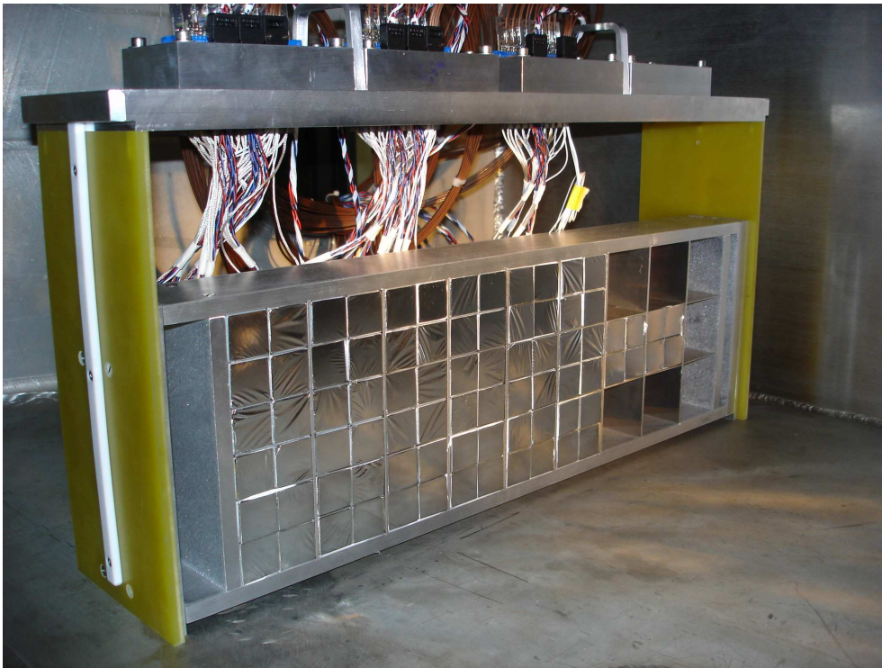
FIGURE 2.14 – Photo des détecteurs CsI. 80 CsI sont réparties sur 6 rangées couvrant une majorité du plan focal.
