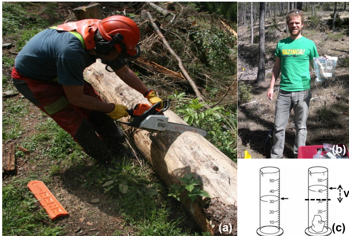
Figure 34 – (a)Prélèvement des échantillons à la tronçonneuse, (b) transport et (c) détermination de leur volume (Cliché Bigot, 2011 et Berger, 2012)
