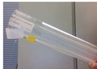
(c) Fibre bobinée à différentes tensions sur un tube en quartz
