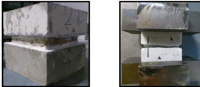
FIGURE J.2 – À gauche, joint de mortier préparé selon le premier protocole GéoRessources et à droite, joint de marbre préparé selon le nouveau protocole
