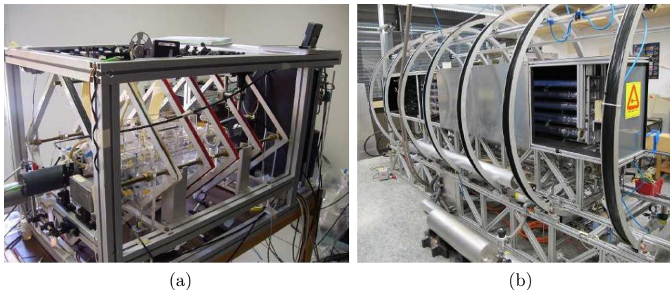
FIGURE B.1.2 – Polariseur sur site développé à l'IR4M avec le laboratoire Kastler Brossel (a). Unité de production située à l'Institut de physique Max Planck permettant d'obtenir des cellules de 1 L à 3 bar polarisées à 70%
