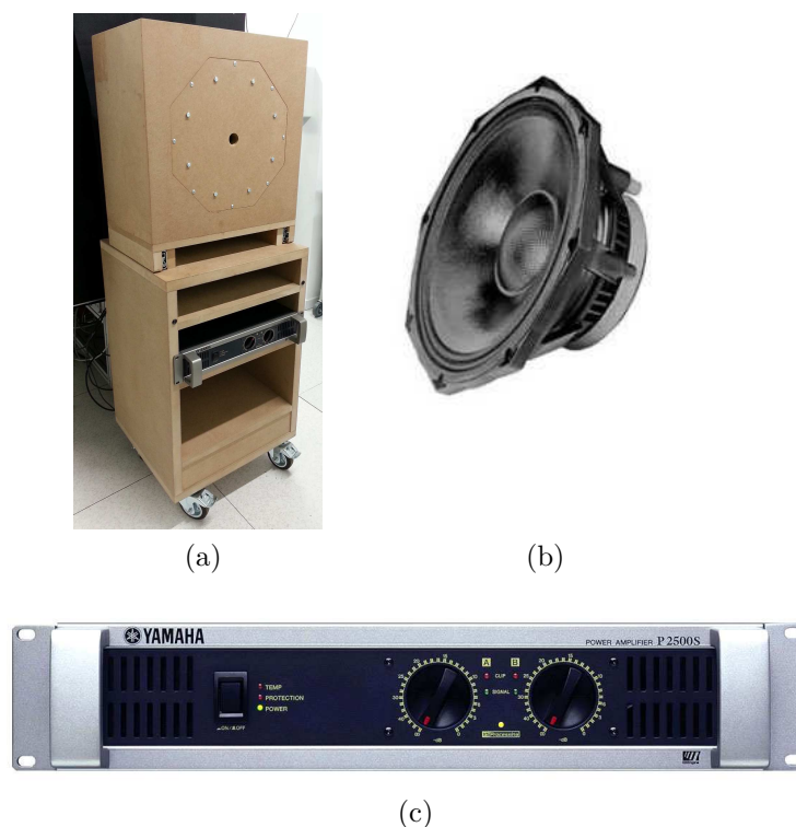
FIGURE 3.2.14 – Photos du générateur d'onde de pression basse-fréquence 20 – 50 Hz optimisé (a), du haut-parleur (b), et de l'amplificateur Yamaha P2500S (c)
