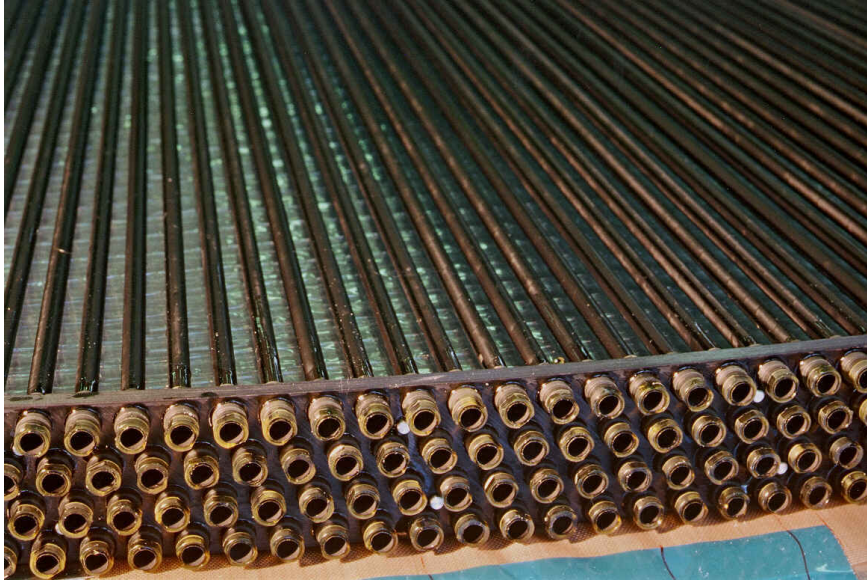
FIGURE 2.15 – Photographie d'un plan de pailles du TRT. Photographie tirée des images publiques d'ATLAS.
