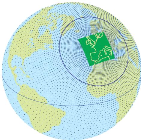
**Figure 4.2** Grilles du modèle ARPEGE en service au début de l'année 2000. Le pôle d'ARPEGE est situé sur la France (pôle d'intérêt) et la grille est étirée. Seul un point sur seize est représenté (source : Pailleux *et al.*, 2000)
