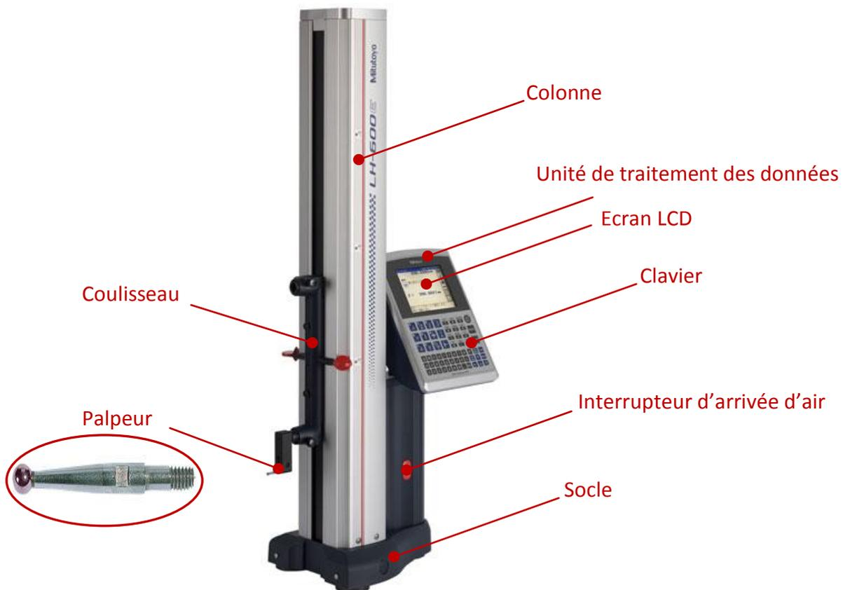
Figure 2-42 : Colonne de mesure LH-600B.
