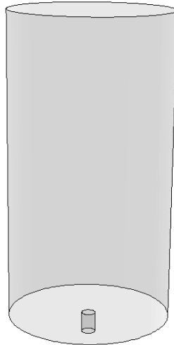
Figure 2.12 : Modèle tridimensionnel de la cuve expérimentale Ø240 mm.
