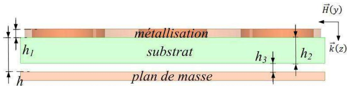
Figure 2.77 - Vue en coupe d'une cellule unité d'un absorbant de type MultiPatches
