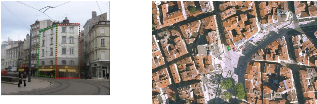
Figure 30 La géolocalisation d'une prise de vue à partir de l'identification de deux façades non-coplanaires. Dans la carte le point vert présente la position réelle et le point rouge la position mesurée. La position réelle est choisie selon des points de repère sur le terrain.
