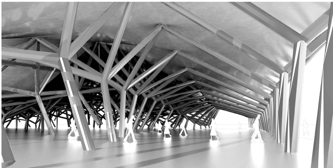
Représentation de la conception de l'auvent conçu en utilisant le champ de vecteurs normal et les surfaces homotopes
