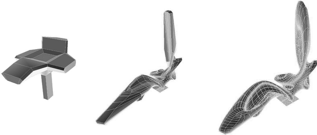
Représentation du maillage polygonal faites par «box modeling» à l'aide un logiciel de CAO
