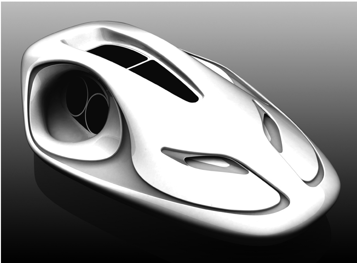
Représentation de la conception extérieure de la peau en utilisant la «box modeling»
