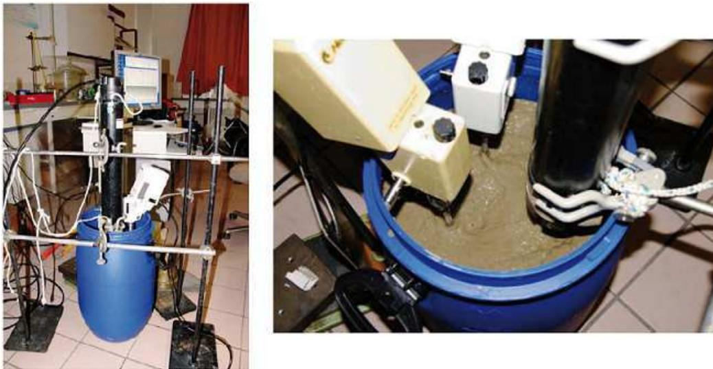
Fig.IV. 3 : Photos du dispositif utilisé afin de calibrer l'ADV Vector avec du sédiment prélevé en Garonne (Dispositif réalisé à l'I2M UMR CNRS 5295 à Bordeaux 1) (Chanson *et al.*, 2011 et Reungoat *et al.*, 2012)
