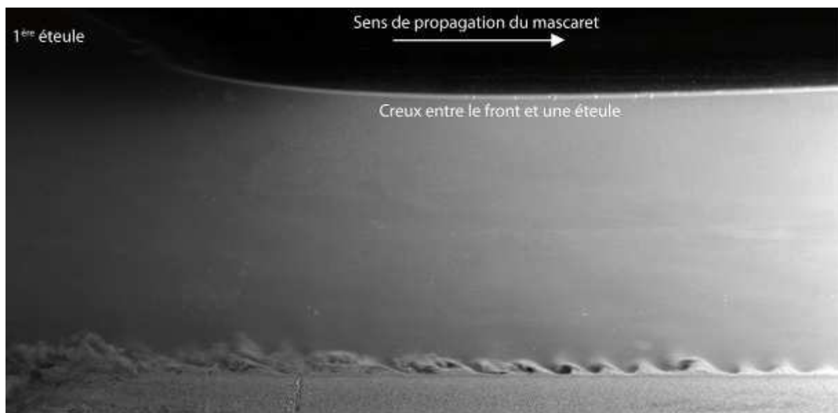
Fig.V. 26 : Instabilités de Kelvin-Helmholtz se développant à l'interface eau/sédiment dans le canal au passage du mascaret (caractéristique d'un écoulement fortement cisailé)
