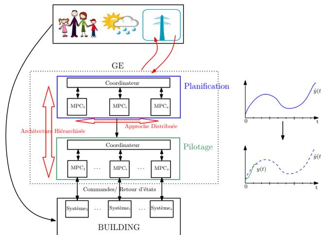
FIGURE 1 – Structure de contrôle prédictive, hiérarchisée et distribuée.
