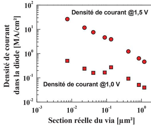
Figure V.20 : Densités de courant délivrées par les diodes PN polarisées en direct à 1 V et 1,5 V, en fonction de la section réelle du via.<sup>2</sup>
