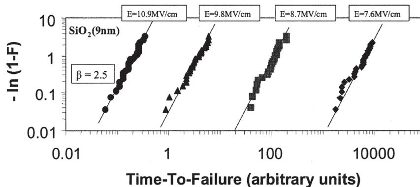
Figure III.9 : Temps au claquage d'une couche de SiO<sub>2</sub> d'épaisseur 9 nm pour divers champs électriques appliqués. [6]
