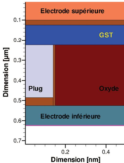
Figure II.24 : Structure utilisée pour la simulation TCAD des dispositifs PCRAM fabriqués au LETI.
