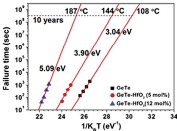
Figure III.46 : Rétention de l'information stockée dans l'état RESET des cellules PCRAM à base GeTe ou de GeTe dopé avec du HfO<sub>2</sub>. [27]
