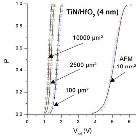
Figure III.11 : Comparaison des probabilités cumulées de claquage en fonction de la tension au claquage d'une couche de HfO<sub>2</sub> déposée sur TiN pour différentes aires de contact. [7]
