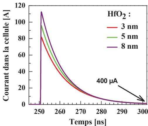
Figure III.37 : Modélisation de l'overshoot de courant se produisant lors du claquage de couches HfO<sub>2</sub> de différentes épaisseurs présentes au sein des dispositifs PCRAM.
