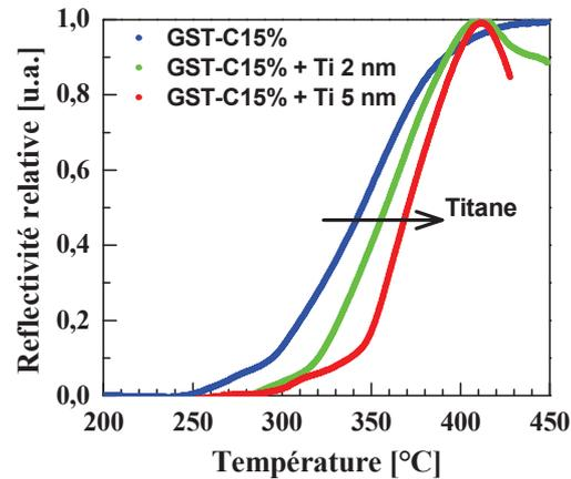
Figure IV.27 : Impact sur la température de cristallisation du GST-C15%, d'une encapsulation par une couche de titane d'épaisseur variable.
