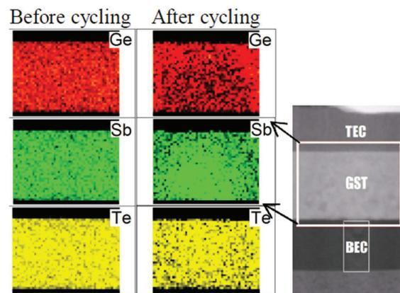
Figure II.9 : Cartographies des concentrations en élément germanium, antimoine et tellure, obtenues par la technique EDX, présentes dans une cellule PCRAM. [2]
