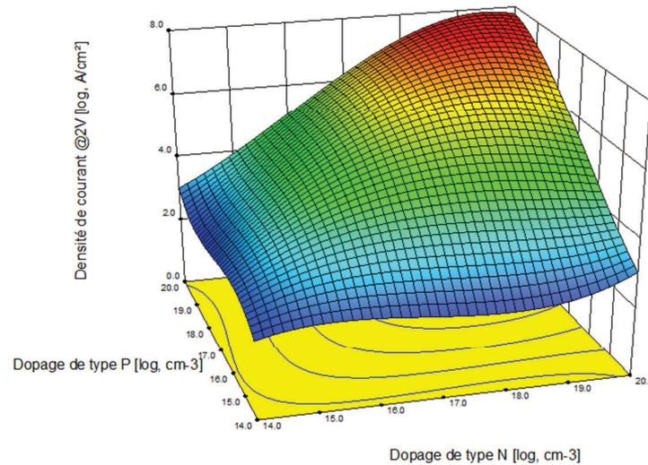
Figure V.6 : Densité de courant traversant la diode PN polarisée en directe à 2V en fonction des valeurs de dopage des zones N et P.
