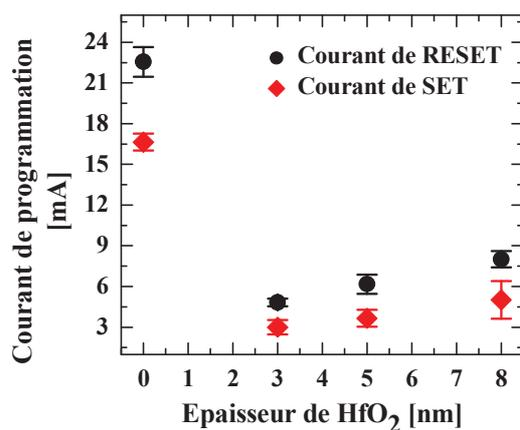
Figure III.20 : Courants de RESET et de SET des dispositifs PCRAM en fonction de l'épaisseur de la couche de HfO<sub>2</sub>.<sup>1</sup>
