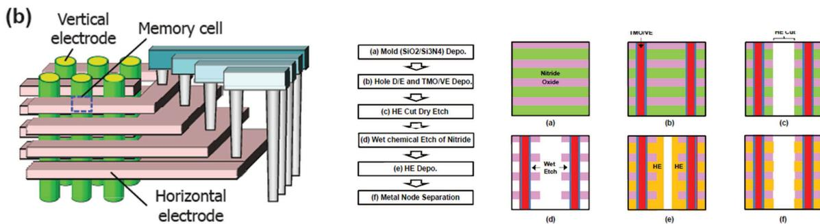
Figure I.50 : Schéma descriptif d'un ensemble de cellules mémoires intégrées au sein de l'architecture verticale. [82]
