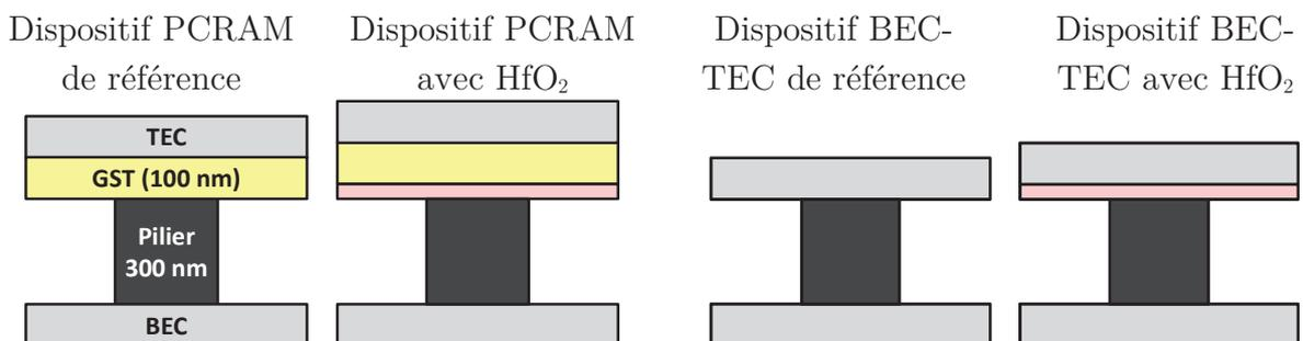
Figure III.6 : Schéma de principe des quatre types de dispositifs à notre disposition. En gris clair, les électrodes supérieures et inférieures ; en gris foncé, le pilier en tungstène ; en jaune la couche de GST et en rose la couche diélectrique en  $\text{HfO}_2$ .
