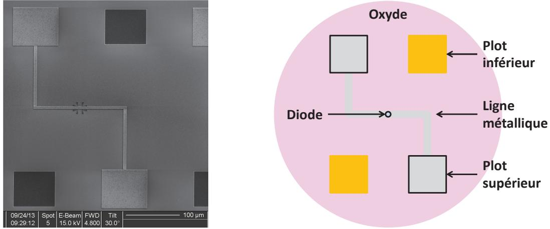
Figure V.3 : Observation aérienne obtenue par la technique d'imagerie MEB d'une diode PN verticale étudiée dans cette thèse (gauche) et schéma correspondant (droite).
