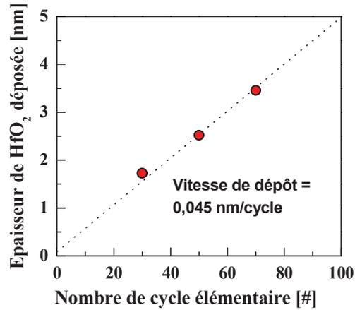
Figure III.5 : Évolution de l'épaisseur de la couche d'oxyde  $\text{HfO}_2$  déposée sur tungstène par la méthode ALD en fonction du nombre de cycles élémentaires effectués.
