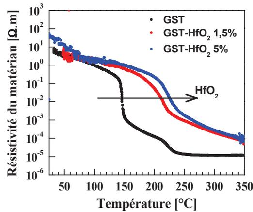
Figure III.47 : Evolution de la résistivité du matériau à changement GST dopé avec différents pourcentages de HfO<sub>2</sub> initialement amorphe en fonction de la température.
