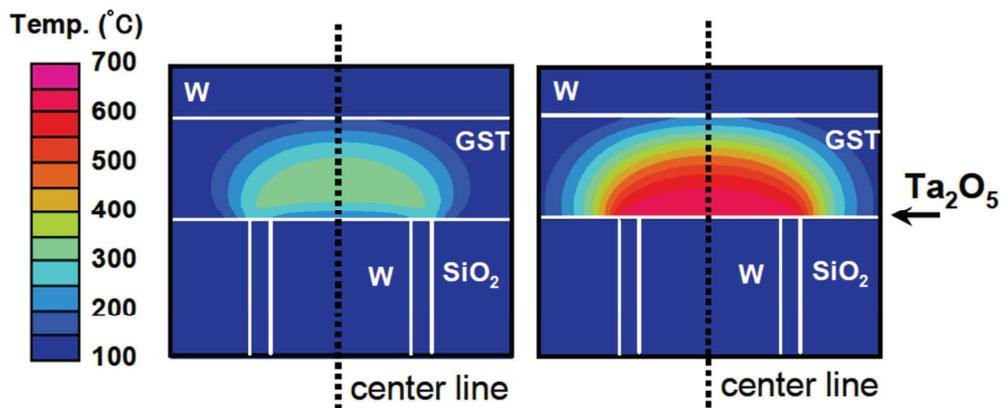
Figure III.2 : Profil de température au sein d'une cellule PCRAM pour un courant de programmation de 100  $\mu\text{A}$  sans (gauche) et avec (droite) une couche d'interface en  $\text{Ta}_2\text{O}_5$ . [1]
