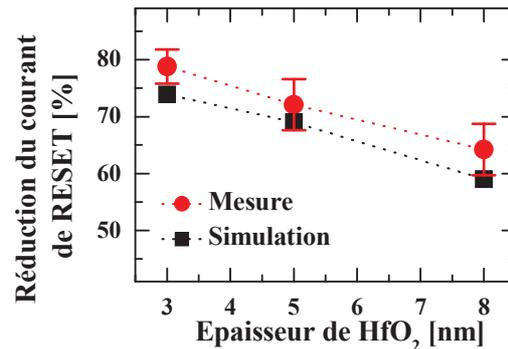
Figure III.42 : Comparaison des réductions des courants de RESET mesurés et simulés pour des dispositifs PCRAM avec des couches de  $\text{HfO}_2$  de différentes épaisseurs.
