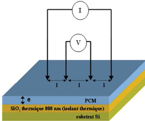
Figure II.12 : Principe de la mesure de la résistivité des matériaux à changement de phase déposés en couche mince.
