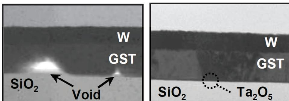
Figure III.1 : Vues en coupe, obtenues par la technique d'imagerie TEM, d'une couche de GST déposée sur  $SiO_2$  (gauche) ou sur  $Ta_2O_5$  (droite). Dans ce second cas aucun décollement n'est visible. [1]
