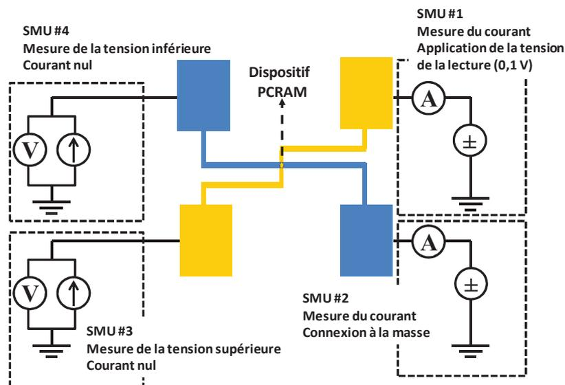
Figure II.16 : Configuration du banc de mesure représenté sur la Figure II.15 utilisée pour mesurer à champ électrique faible la résistance d'un dispositif PCRAM.
