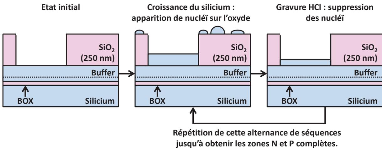
Figure V.9 : Schéma de principe de l'enchaînement des étapes technologiques utilisées au LETI pour obtenir des diodes PN en silicium déposé par épitaxie sélective cyclique.
