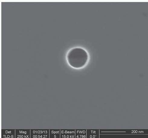
Figure V.10 : Observation aérienne, obtenue par la technique d'imagerie MEB, de la surface de la plaque après l'étape d'épitaxie sélective cyclique des zones P et N.
