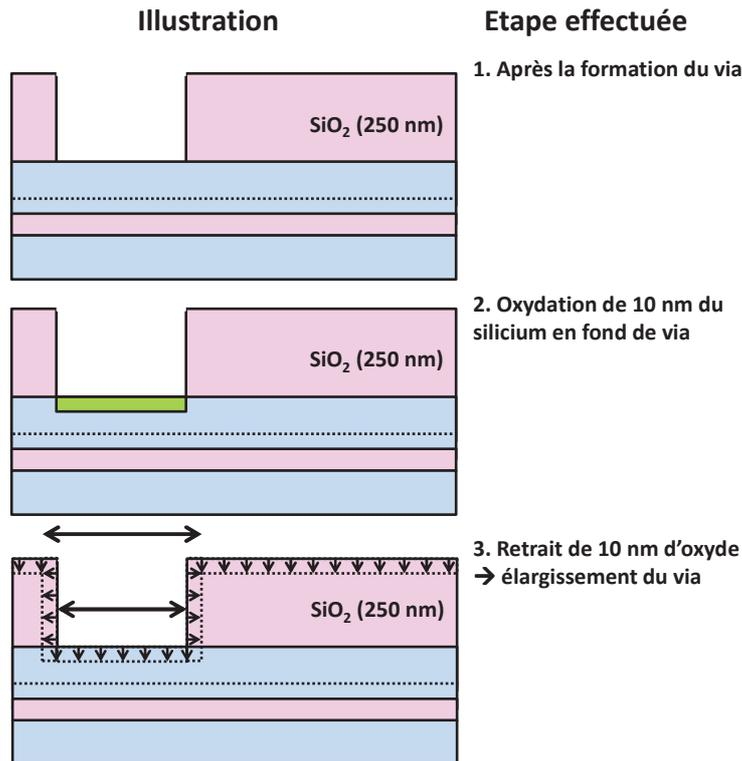
Figure V.12 : Schéma de principe de l'enchaînement des étapes technologiques utilisées au LETI pour préparer la surface de silicium avant l'étape d'épitaxie.
