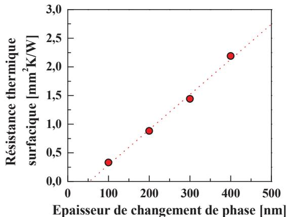
Figure IV.19 : Résistance thermique surfacique du GST-C4% mesurée à 185°C en fonction de l'épaisseur de la couche étudiée.
