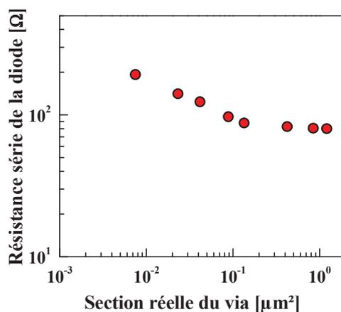
Figure V.23 : Résistances séries des diodes PN polarisées en direct au-delà de 1,3 V, en fonction de la section réelle du via.<sup>3</sup>
