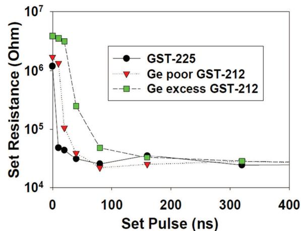
Figure II.20 : Exemple de courbes permettant de caractériser la rapidité de la programmation des dispositifs PCRAM à base de GST et de  $\text{Ge}_2\text{Sb}_1\text{Te}_2$  enrichi ou appauvri en germanium. [13]
