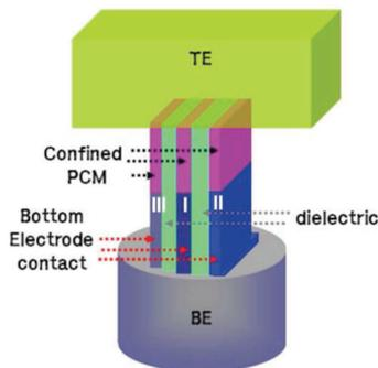
Figure I.30 : Schéma de principe d’une cellule PCRAM utilisant trois zones actives en parallèle permettant de stocker 2 bits par cellule. [51]
