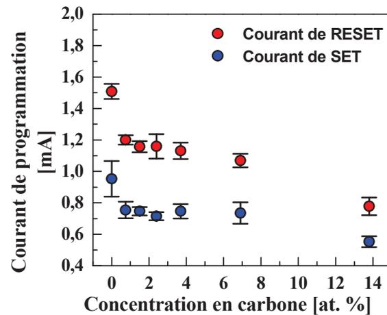
Figure IV.8 : Courants de RESET et de SET des dispositifs PCRAM en fonction de la teneur en carbone du GST.<sup>1</sup>
