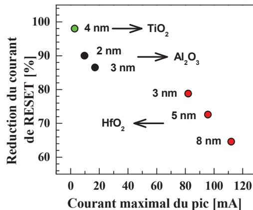
Figure III.44 : Lien entre la réduction des courants de RESET des dispositifs PCRAM et le courant maximal traversant le dispositif pendant l'étape de claquage.
