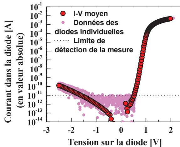
Figure V.15 : Caractéristiques I-V des diodes de diamètre dessiné 50 nm.<sup>1</sup>
