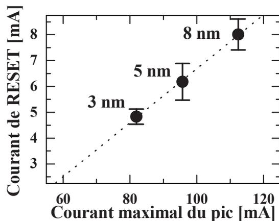
Figure III.39 : Lien entre le courant maximal traversant le dispositif PCRAM pendant le claquage de la couche de HfO<sub>2</sub> et le courant de RESET du même dispositif PCRAM.
