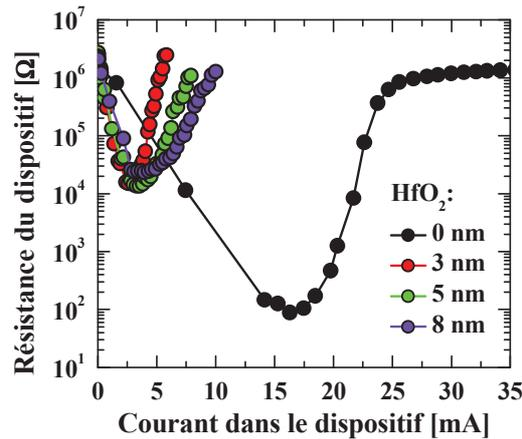
Figure III.19 : Caractéristiques R-I des dispositifs PCRAM avec et sans couche de HfO<sub>2</sub>.
