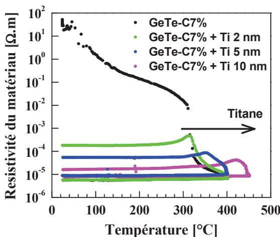
Figure IV.34 : Impact, sur la température de cristallisation du matériau à changement de phase, d'une encapsulation par une couche de titane d'épaisseur variable d'une couche de GeTe-C7%.
