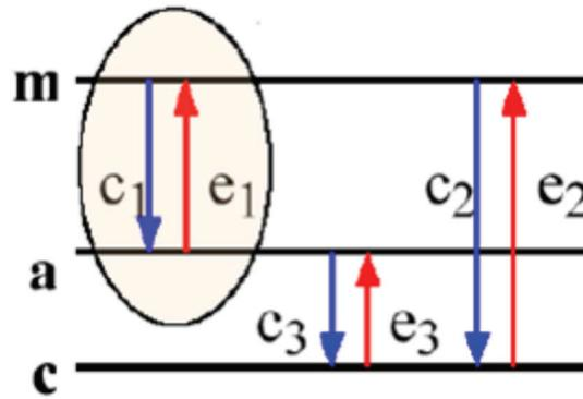
Figure II.25 : Représentation symbolique des différents états du matériau à changement de phase (m pour l'état liquide, a pour l'état amorphe et c pour l'état cristallin) et des transitions associées.
