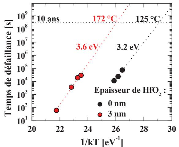
Figure III.27 : Graphe d'Arrhenius de l'état RESET des dispositifs PCRAM avec et sans couche de HfO<sub>2</sub> d'épaisseur 3 nm.
