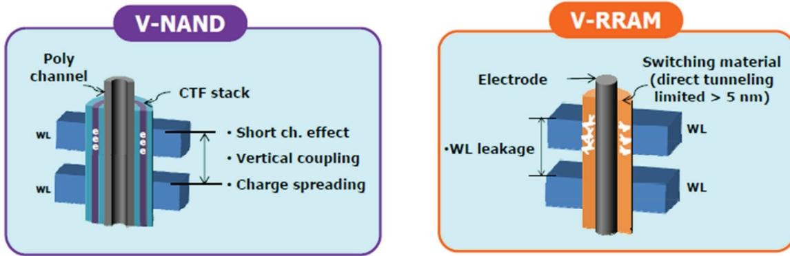
Figure I.49 : Schéma descriptif d'une cellule mémoire Flash à canal vertical (gauche) et d'une cellule mémoire résistive verticale (droite).
