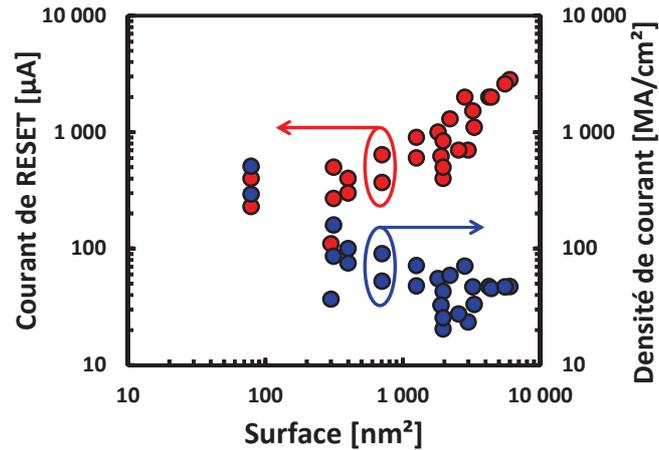
Figure I.33 : Évolution du courant de RESET et de la densité de courant correspondante en fonction de la surface du pilier des cellules PCRAM. Données extraites de [33], [55], [56], [57], [58], [59], [60].
