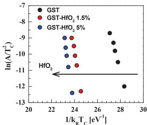
Figure III.48 : Graphe de Kissinger du matériau à changement de phase GST dopé avec différents pourcentages de HfO<sub>2</sub>.
