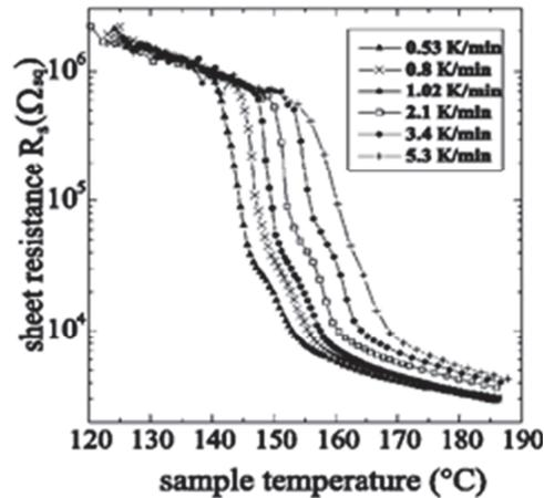
Figure II.14 : Évolution de la résistivité du GST initialement amorphe en fonction de la température pour différentes rampes de température. [10]
