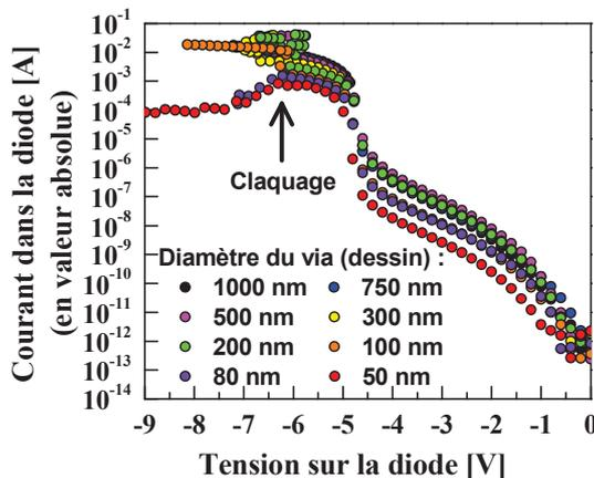
Figure V.27 : Caractéristiques I-V des diodes de diamètre variable polarisées en inverse.
