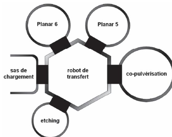
Figure II.3 : Schéma descriptif des machines utilisées pour le dépôt du matériau à changement de phase.
