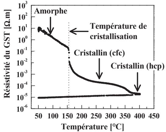
Figure II.13 : Evolution de la résistivité d'une couche de GST d'épaisseur 100 nm initialement amorphe en fonction de la température.
