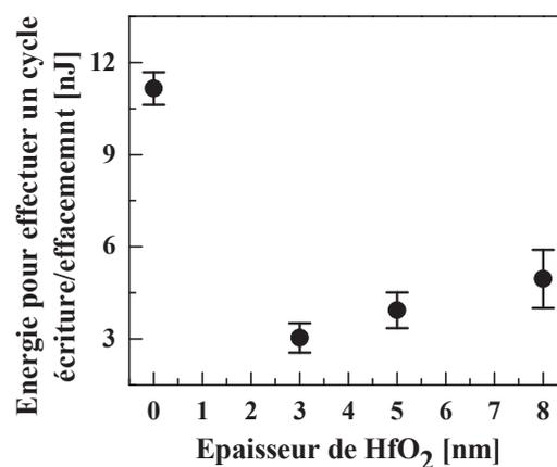
Figure III.21 : Énergie requise pour effectuer un cycle d'écriture/effacement du dispositif PCRAM en fonction de l'épaisseur de la couche de HfO<sub>2</sub>.<sup>1</sup>
