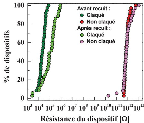
Figure III.31 : Évolution des résistances des dispositifs PCRAM avec une couche de HfO<sub>2</sub> claquée ou non lors de l'étape de soudure de la matrice mémoire sur une carte électronique.
