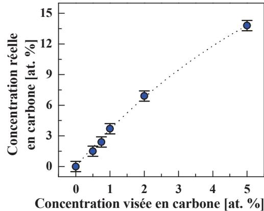
Figure IV.6 : Comparaison entre la concentration réelle en carbone au sein du GST et la concentration visée.
