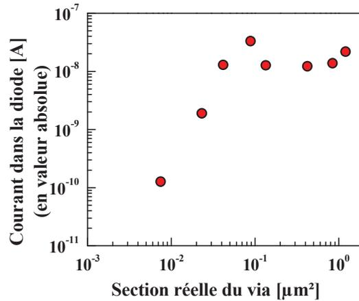
Figure V.26 : Courants délivrés par les diodes PN polarisées en inverse à -2,5 V, en fonction de la section réelle du via.<sup>4</sup>
