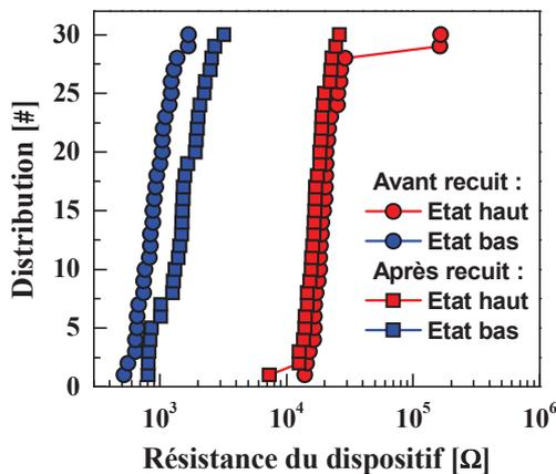
Figure IV.32 : Évolution des valeurs de résistance des dispositifs PCRAM à base de GST-C15% encapsulé avec une couche de 5 nm de titane lors de l'étape de soudure de la matrice mémoire sur une carte électronique.
