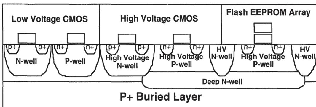
Figure I.43 : Représentation schématique d'une matrice mémoire utilisée pour une application embarquée. Les cellules mémoires se trouvent au même niveau que les éléments de la logique CMOS. [73]
