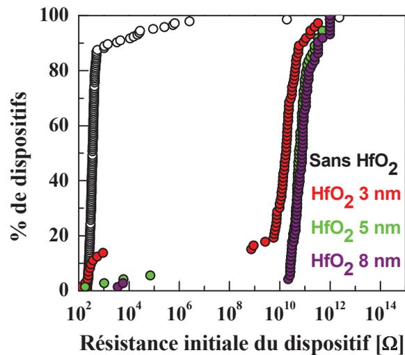
Figure III.8 : Résistance initiale des dispositifs PCRAM avec et sans couche de HfO<sub>2</sub>.<sup>1</sup>
