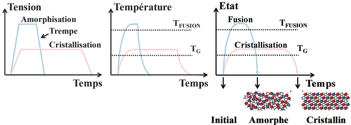
Figure I.21 : Représentation schématique des impulsions électriques à appliquer sur les cellules PCRAM pour les programmer (gauche) et évolutions temporelles de la température (centre) et de l'état (droite) du matériau à changement correspondantes.
