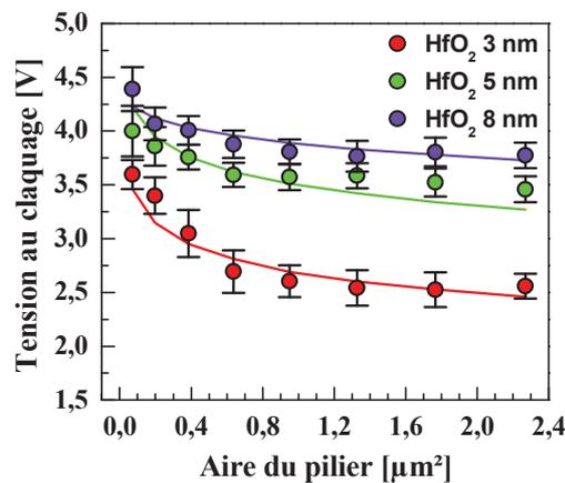
Figure III.18 : Dépendance de la tension au claquage de la couche de  $\text{HfO}_2$  des dispositifs de type PCRAM à base de GST en fonction de l'épaisseur de  $\text{HfO}_2$  et de l'aire du pilier en tungstène. Les données expérimentales sont représentées par les symboles tandis que les lignes correspondent à la modélisation obtenue à l'aide des équations 2, 3 et 4.<sup>1</sup>
