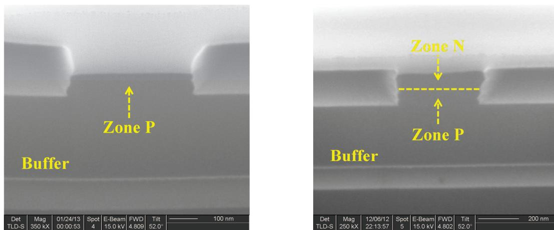
Figure V.11 : Observation en coupe, obtenue par la technique d'imagerie MEB, d'un via de diamètre dessiné 300 nm après l'étape d'épithaxie sélective cyclique de la zone P (gauche) et de la zone N (droite).
