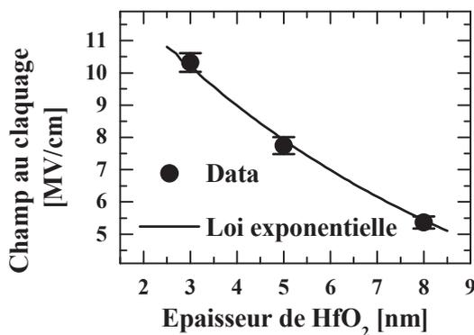
Figure III.16 : Champ au claquage de la couche de HfO<sub>2</sub> intégrée dans des dispositifs BEC-TEC à pilier de 300 nm de diamètre en fonction de l'épaisseur de HfO<sub>2</sub>.<sup>1</sup>
