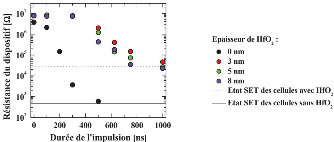
Figure III.22 : Lien entre la durée de l'impulsion appliquée aux dispositifs PCRAM intégrant des couches de  $\text{HfO}_2$  d'épaisseurs variables et la résistance obtenue après l'application de cette impulsion.
