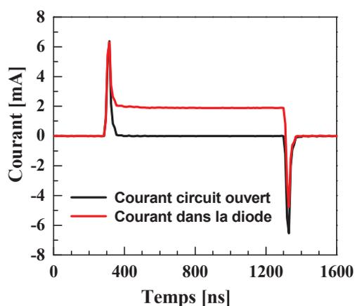
Figure V.32 : Profil temporel du courant traversant la diode pendant l'application d'une impulsion de tension de durée  $1\ \mu\text{s}$ . La courbe noire correspond au profil temporel du courant traversant le montage en circuit ouvert (c'est-à-dire sans la diode).
