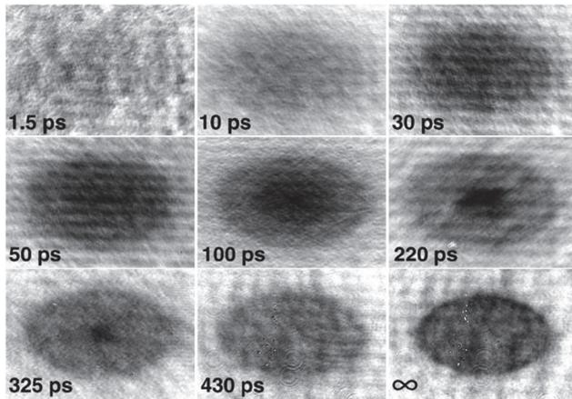
Figure I.23 : Mesure, résolue en temps, de la réflectivité d'une couche de GST amorphisée à l'aide d'une impulsion laser appliquée à  $t = 0$  ps. Après 430 ps la zone amorphe est complètement formée. [38]
