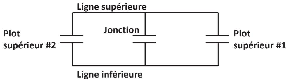
Figure V.34 : Schéma électrique équivalent de notre structure de diode.
