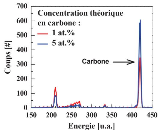
Figure II.7 : Exemple de spectre NRA d'un échantillon déposé au LETI de GST dopé avec 1 at.% (en rouge) et 5 at.% de carbone (en bleu).
