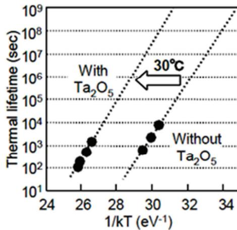
Figure III.45 : Rétention de l'information stockée dans l'état RESET des cellules PCRAM avec et sans couche de Ta<sub>2</sub>O<sub>5</sub> d'épaisseur 2 nm. [1]
