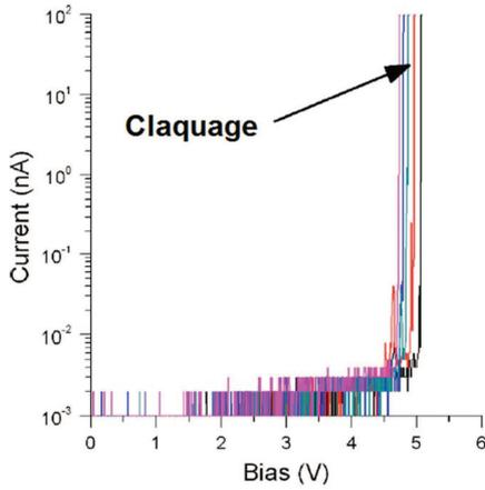
Figure III.10 : Caractéristiques I-V d'une couche de HfO<sub>2</sub> déposée sur TiN obtenues à l'aide d'un AFM conducteur. [7]
