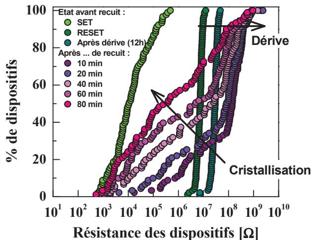
Figure III.26 : Évolution des valeurs de résistance des dispositifs PCRAM avec HfO<sub>2</sub> pour différentes étapes de la procédure de caractérisation de la rétention de l'information à 235°C.
