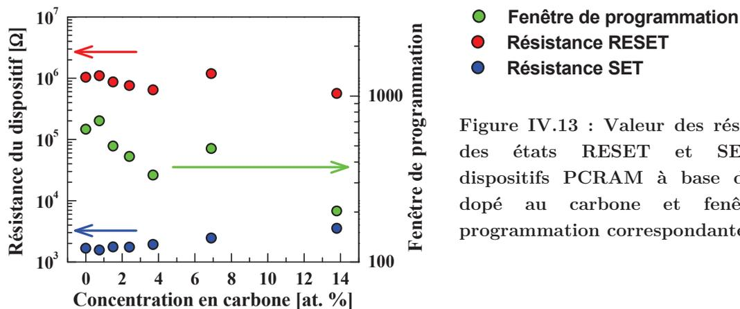
Figure IV.13 : Valeur des résistances des états RESET et SET des dispositifs PCRAM à base de GST dopé au carbone et fenêtre de programmation correspondante.
