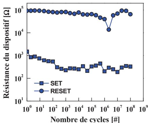
Figure IV.28 : Stabilité des dispositifs PCRAM dans l'état amorphe après dépôt à 300°C base de GST-C15% encapsulé ou pas par une couche de titane.<sup>3</sup>
