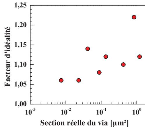
Figure V.22 : Facteur d'idéalité des diodes PN polarisées en direct en fonction de la section réelle du via.<sup>3</sup>
