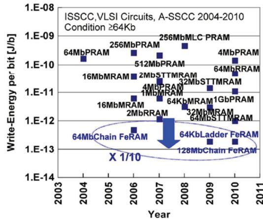
Figure I.34 : Consommation énergétique reportée entre 2004 et 2010 des différentes technologies mémoires émergentes. [61]
