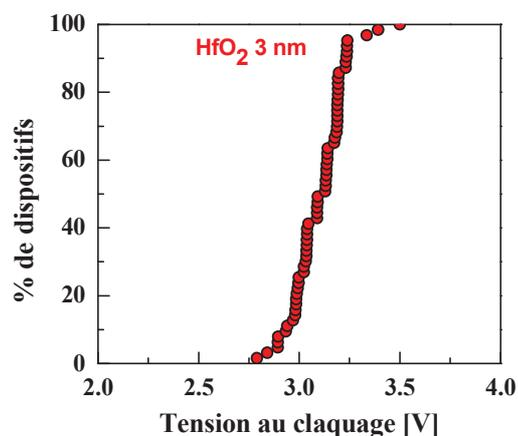
Figure III.14 : Tension au claquage des dispositifs BEC-TEC intégrant une couche de  $\text{HfO}_2$  d'épaisseur 3 nm.<sup>2</sup>
