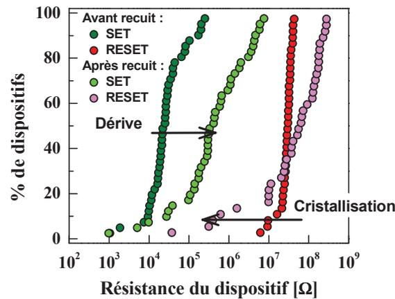
Figure III.29 : Évolution des valeurs de résistance des dispositifs PCRAM dans les états RESET et SET lors de l'étape de soudure de la matrice mémoire sur une carte électronique.
