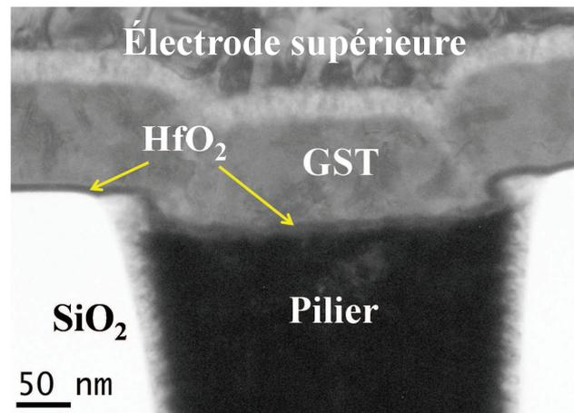
Figure III.7 : Vue en coupe, obtenue par la technique d'imagerie TEM d'un dispositif PCRAM intégrant une couche d'épaisseur 8 nm en  $\text{HfO}_2$  entre le GST et le pilier en tungstène.
