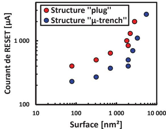
Figure I.41 : Lien entre le courant de RESET des cellules PCRAM et la surface de la zone active pour des cellules à structure “plug” et “µ-trench”. Données extraites de [56] et [57].
