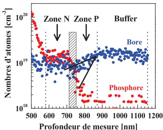
Figure V.18 : Profils en profondeur, obtenus par la technique ToF-SIMS, des dopants bore (bleu) et phosphore (rouge) au sein des diodes dopées au bore à  $2.10^{17} \text{ cm}^{-3}$ . La zone hachurée met en évidence la zone de contact entre les zones N et P (jonction métallurgique).
