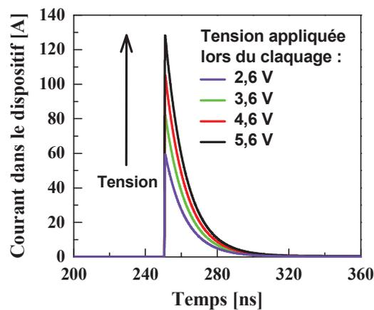
Figure III.43 : Lien entre la tension appliquée lors du claquage de la couche de HfO<sub>2</sub> et l'overshoot de courant se produisant lors du claquage.
