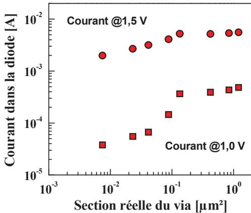
Figure V.19 : Courants délivrés par les diodes PN polarisées en direct à 1 V et 1,5 V, en fonction de la section réelle du via.<sup>2</sup>
