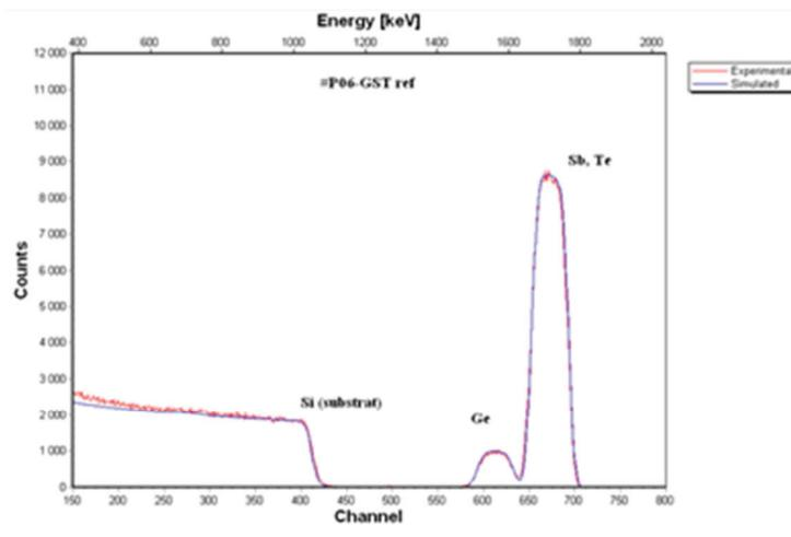
Figure II.5 : Exemple de spectres RBS d'un échantillon de GST déposé au LETI.
