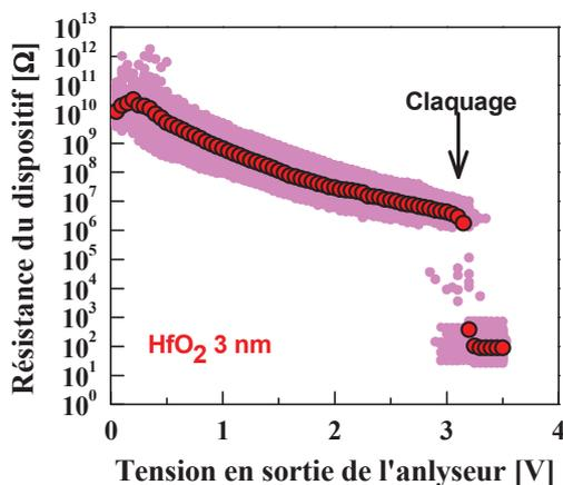
Figure III.13 : Résistance des dispositifs BEC-TEC intégrant une couche de  $\text{HfO}_2$  d'épaisseur 3 nm en fonction de la tension en sortie de l'analyseur de paramètres.<sup>1</sup>
