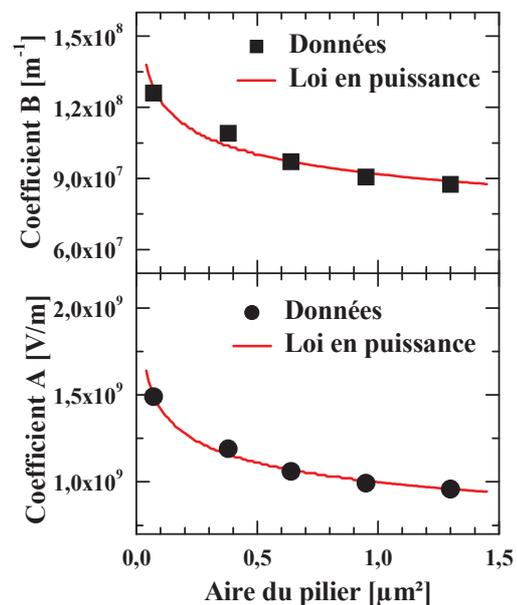
Figure III.17 : Coefficients A et B en fonction de l'aire du pilier.<sup>1</sup>
