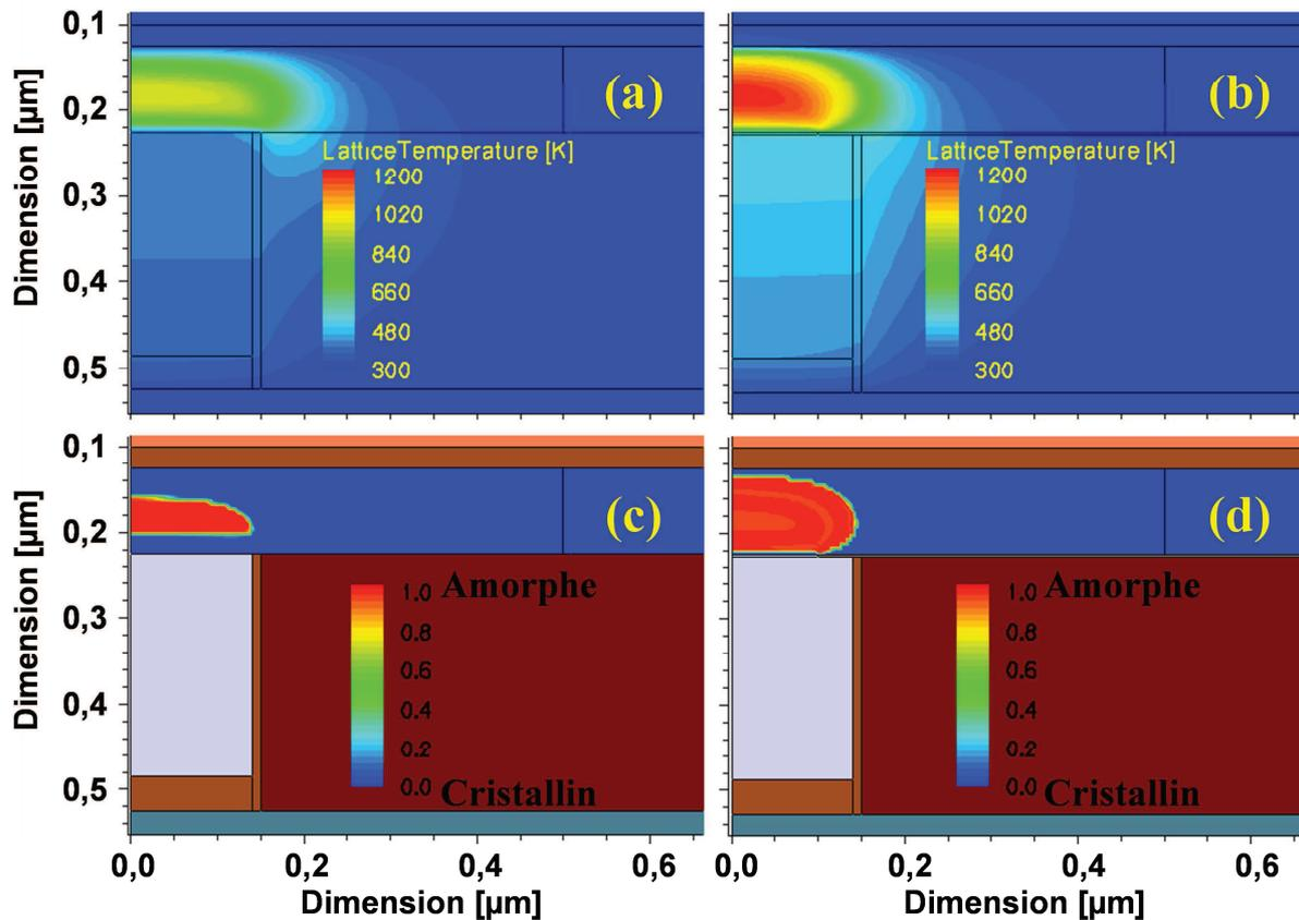
Figure III.33 : Profil de température obtenu au sein de dispositifs PCRAM de référence (gauche) et avec une couche de  $\text{HfO}_2$  d'épaisseur 3 nm (droite) pendant l'application d'une impulsion de courant (a), (b) et état correspondant obtenu suite à l'application de l'impulsion (c), (d).
