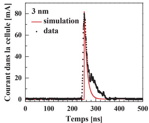
Figure III.38 : Comparaison entre les overshoots de courant modélisé et mesuré se produisant lors du claquage de la couche de HfO<sub>2</sub> d'épaisseur 3 nm présente au sein des dispositifs PCRAM.
