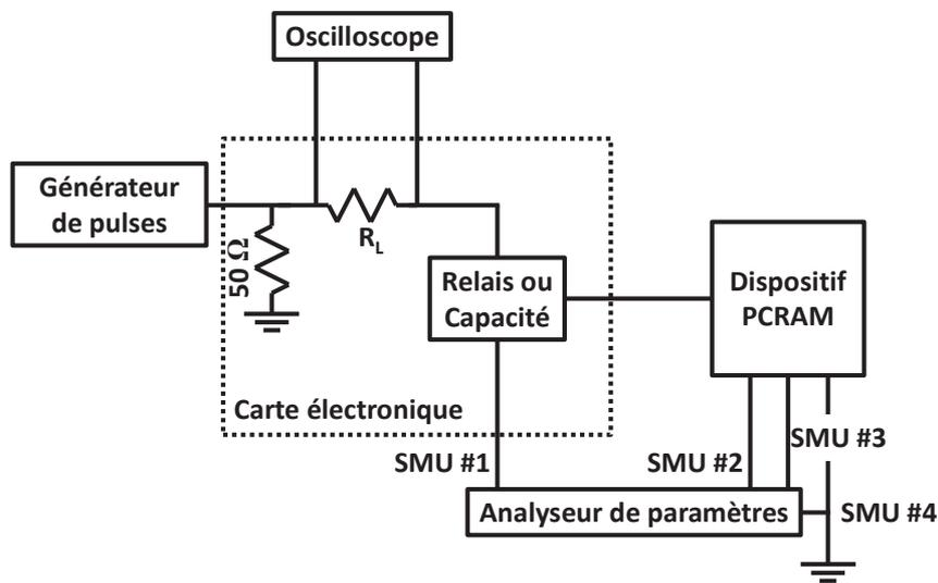
Figure II.15 : Schéma de principe simplifié du banc de mesure utilisé pour appliquer des impulsions électriques sur un dispositif PCRAM.
