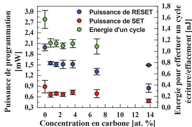
Figure IV.9 : Puissances de RESET et SET et énergie requise pour effectuer un cycle d'écriture/effacement des dispositifs PCRAM en fonction de la teneur en carbone du GST.<sup>1</sup>
