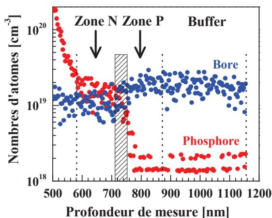
Figure V.17 : Profils en profondeur, obtenus par la technique ToF-SIMS, des dopants bore (bleu) et phosphore (rouge) au sein des diodes dopées au bore à  $2.10^{19} \text{ cm}^{-3}$ . La zone hachurée met en évidence la zone de contact entre les zones N et P (jonction métallurgique).
