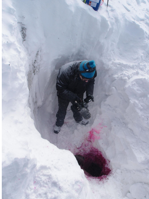
FIG. 14 – cavité formée après l'injection des traceurs
