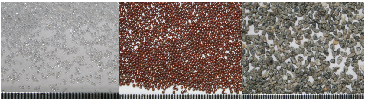
Figure 2.1: Photos des billes de verre, d'oxyde de zircon, et des grains de phonolite, respectivement. Les graduations représentent un demi-millimètre.
