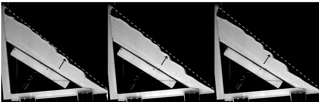
Figure 4.5: Exemple d'expérience présentant une instabilité d'érosion dans le canal de 6mm, avec création de marches. Le débit est de 3.3 g/s et la pente initiale de 39.3°. Les pointillés blancs indiquent la forme initiale du tas. Les trois images sont prises à 15 minutes d'intervalles après une heure d'expérience, et permettent de visualiser la propagation des structures. La flèche noire par exemple, suit la remontée d'une des marches.
