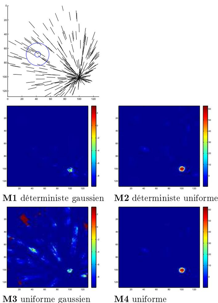
FIGURE 4.18 – Echantillon gaussien en direction du point  $M(36, 36)$  avec une surdensité de segments parallèles alignés dans la direction du point  $M$ . La surdensité n'est pas significative contre les modèles gaussiens. La convergence globale est significative contre les modèles uniformes.
