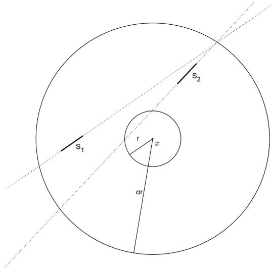
FIGURE 4.4 – Modélisation des convergences locales par des couronnes de rayon intérieur  $r$ , de rayon extérieur  $\alpha r$  avec  $\alpha > 1$ . Sur cet exemple,  $S_1$  ne converge pas vers le centre  $B(\mathbf{x}, r)$ , contrairement à  $S_2$  donc  $N(\mathbf{x}, r, \alpha) = 2$  et  $K(\mathbf{x}, r, \alpha) = 1$ .
