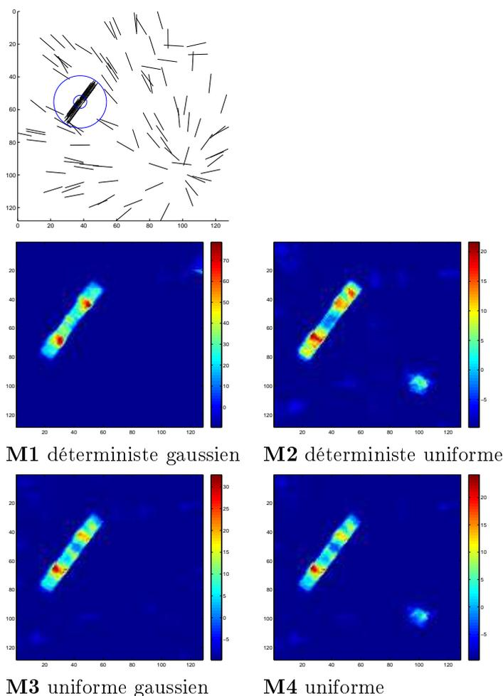
FIGURE 4.19 – Echantillon gaussien en direction du point  $M(36, 36)$  avec une surdensité de segments parallèles non alignés dans la direction de convergence globale. Le point de convergence globale est significatif contre les modèles où l'orientation est uniforme, mais n'est pas détecté lorsqu'on teste contre les modèles gaussiens. La surdensité de segments parallèles est plus significative contre les modèles gaussiens.
