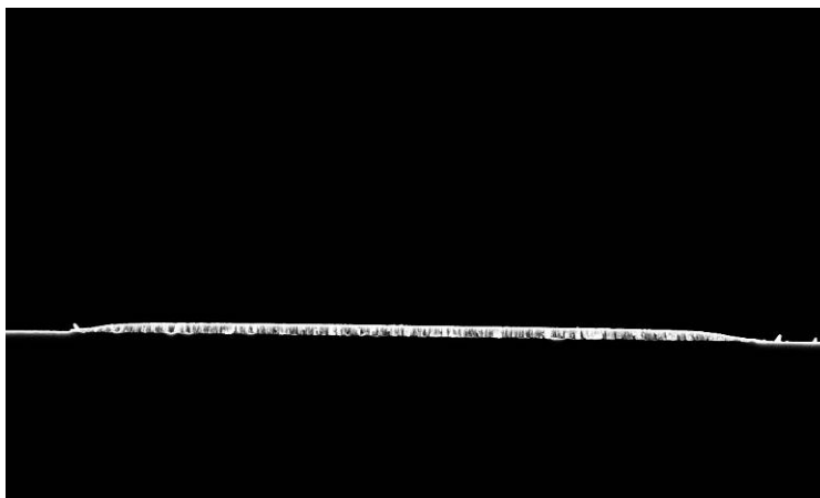
Figure G.3. Photographie au MEB montrant le motif de Cr sur Ge obtenu par "lift-off".
