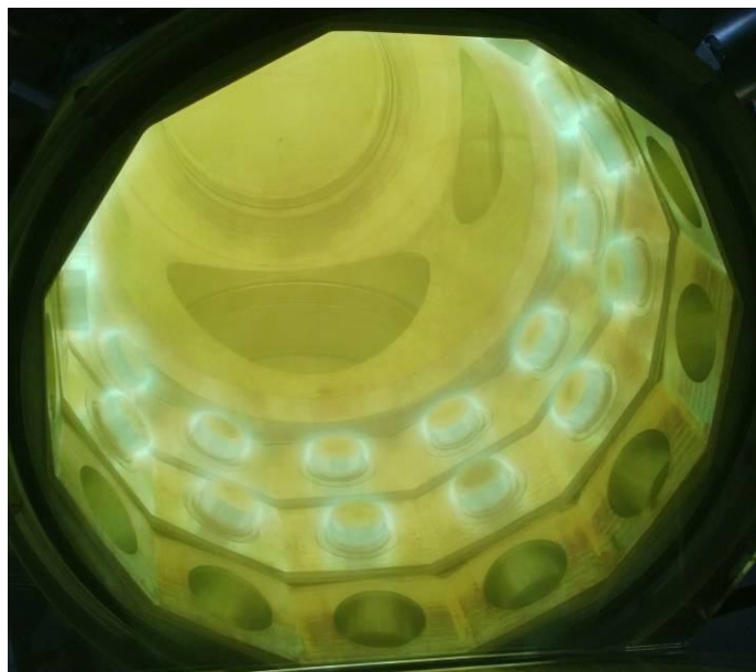
Figure 7.15. Photographie d'un plasma d'iode. La pression de I_2 est de 0,5 mTorr et la puissance micro-onde de 60 W/source.
