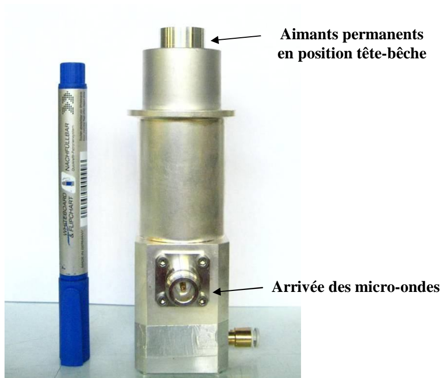
Figure 7.3. Photographie d'un applicateur micro-onde.
