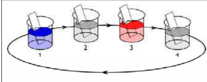
**Figure 2.1 :** Construction d'un film multicouche par trempage. Les étapes de trempage sont réalisées respectivement dans les solutions de 1) polycations, 2) tampon, 3) polyanions et 4) tampon (Decher 1997).
