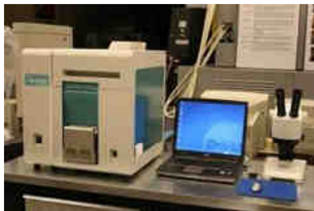
Figure 2.20 : Photographie du MEB environnemental utilisé (Hitachi TM-1000).
