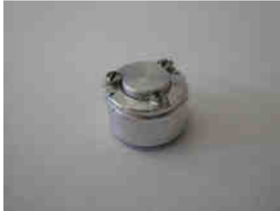
Figure 2.4 : Photographie du dispositif de maintien d'échantillons en PDMS à l'état étiré.
