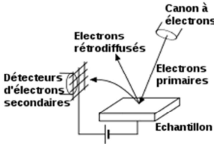
**Figure 2.19 :** Principe de fonctionnement d'un microscope électronique à balayage (wikipedia). Le canon produit un faisceau d'électrons qui balayent la surface d'un échantillon. Des particules telles que des électrons secondaires ou rétrodiffusés sont réémis et les signaux sont récupérés par différents détecteurs.
