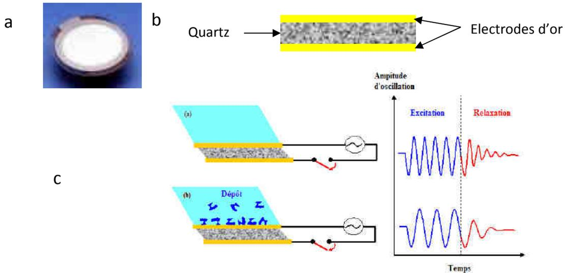
**Figure 2.6 :** (a) Photo et (b) coupe schématique du cristal de quartz utilisé pour les mesures de QCM (c) schéma de principe de la mesure par QCM-D.
