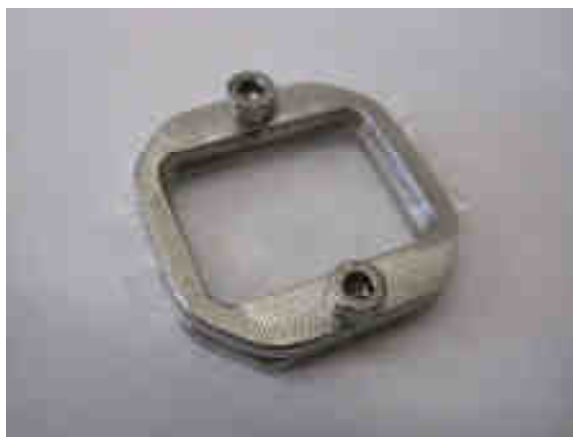
Figure 2.5 : Photographie du dispositif de maintien d'échantillons en PDMS pour la culture cellulaire.
