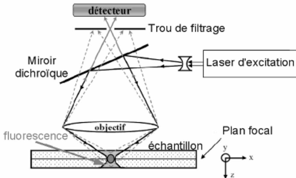
**Figure 2.18 :** Schéma de principe d'un microscope confocal à balayage laser. La source laser est condensée par l'intermédiaire d'une première lentille, d'un miroir dichroïque et de l'objectif en un point focal. La fluorescence émise par l'échantillon est ensuite recueillie par un photomultiplicateur. Pour éliminer la fluorescence parasite, le trou de filtrage (pinhole) est disposé au niveau du plan image de l'objectif (Université Claude Bernard Lyon I).
