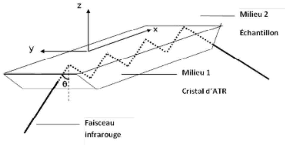
**Figure 2.16 :** Faisceau infrarouge traversant un cristal trapézoïdal d'ATR. Le faisceau entre normalement par une des faces du cristal ( $\alpha = 45^\circ$ ) et frappe l'interface entre le cristal (milieu 1) et la solution aqueuse (milieu 2). Le faisceau crée une onde évanescente dans le milieu 2 au-dessus du cristal d'ATR. Le faisceau est ainsi réfléchi plusieurs fois avant de ressortir par l'autre face du prisme. L'intensité du faisceau sortant est alors mesurée par un détecteur.
