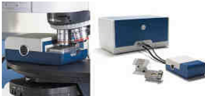
Figure 2.7 : Photographie du modèle QCM-D E1 (Q-Sense)
