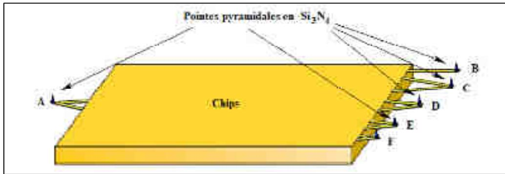
**Figure 2.9 :** Schéma d'un support de cantilevers à pointes pyramidales de constantes de raideur différentes (modèle MSCT-AUHW, Veeco). Généralement, seuls les cantilevers C et D à faible raideur ( $0,03 \text{ N.m}^{-1}$  et  $0,07 \text{ N.m}^{-1}$ ) sont utilisés pour l'imagerie des films de polyelectrolytes.
