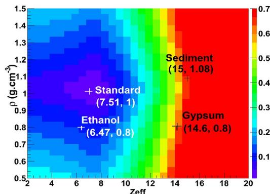
FIGURE 5.10 – Représentation en 2D de la correction de l'auto-absorption. Projection horizontale de  $C_{auto}$  sur les axes  $Z_{eff}$  et  $\rho$ .
