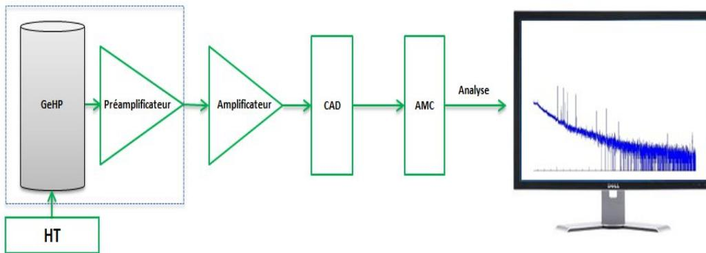
FIGURE 2.2 – Schéma simplifié d'une chaîne de spectrométrie  $\gamma$ .
