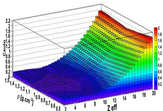
FIGURE 5.9 – Représentation en 3D de la correction de l'auto-absorption en fonction de  $Z_{eff}$  et  $\rho$ .
