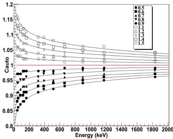
FIGURE 5.2 – Facteurs de correction d'auto-absorption  $C_{auto} = F(E, \rho)$  simulés par MCNPX pour une matrice eau avec des densités arbitraires
