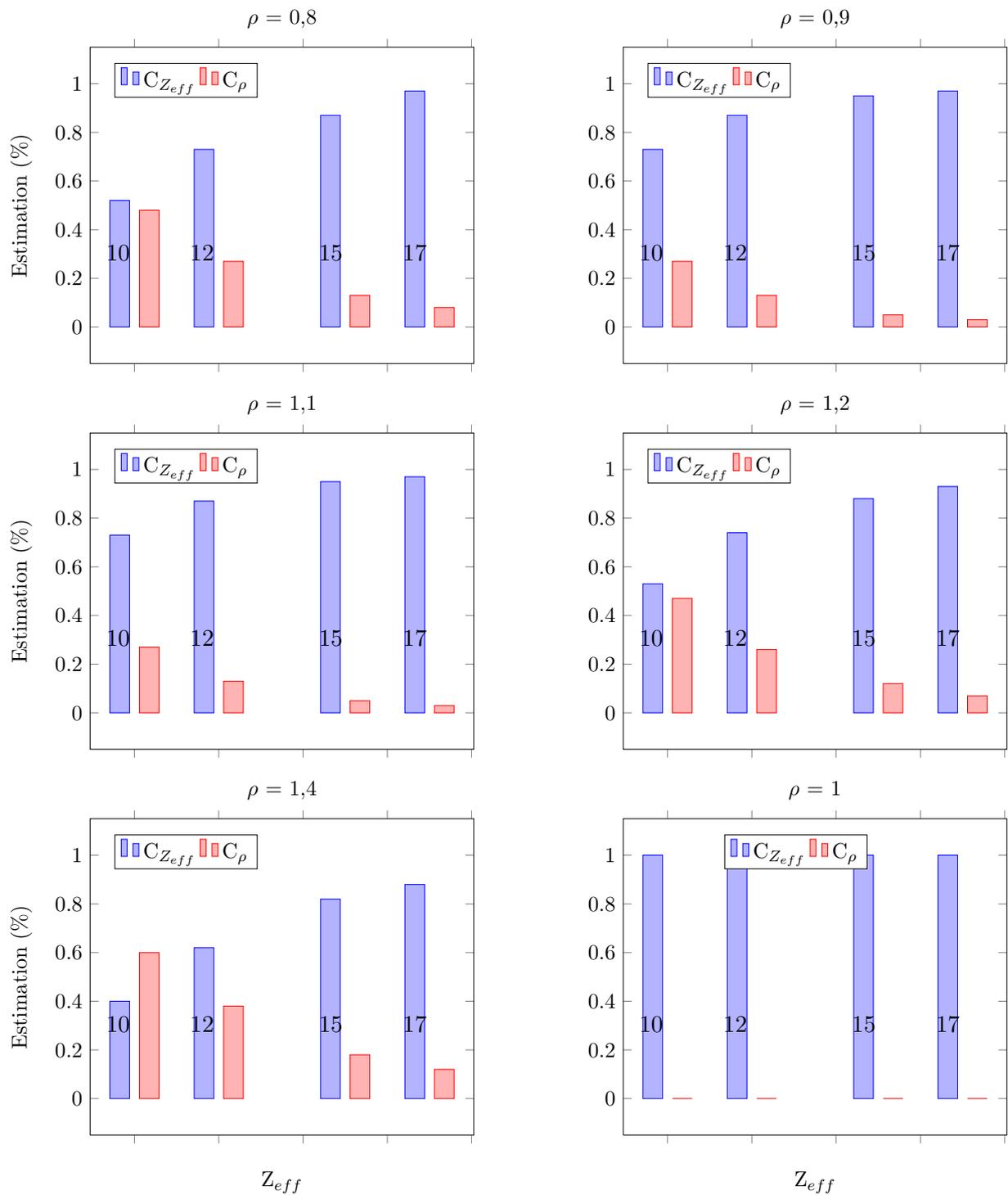
FIGURE 5.8 – Corrections dues à la densité  $\rho$  et la composition élémentaire  $Z_{eff}$  de l'échantillon à 46 keV.
