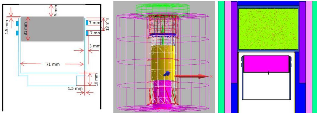
FIGURE 4.12 – De gauche à droite : schéma du détecteur dans son capot ; visualisation en 3D du dispositif expérimentale simulé par MCNPX ; visualisation par Vised de dispositif expérimental.
