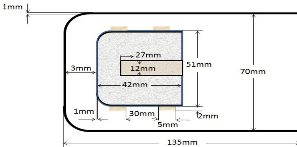
FIGURE 4.23 – Schéma et dimensions du détecteur INTER.
