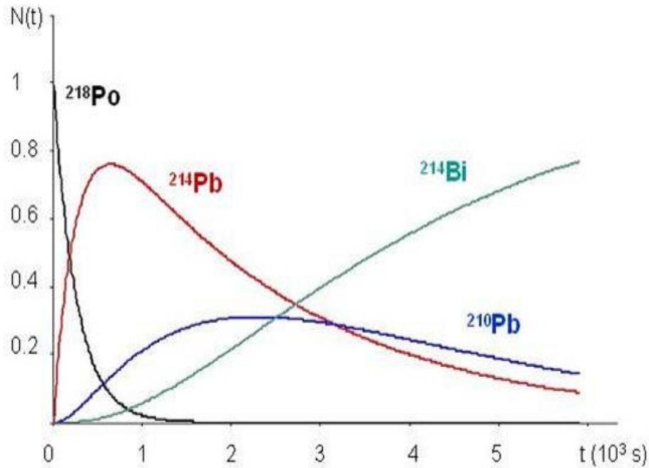
FIGURE 1.5 – Chaîne de décroissance de descendants du  $^{222}\text{Rn}$ .
