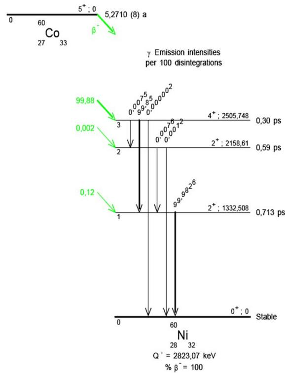
FIGURE 4.1 – Schéma de désintégration du  $^{60}\text{Co}$  [LNHB 2010]
