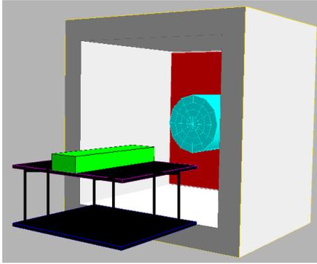
FIGURE 4.24 – Visualisation 3D du dispositif mis en place pour une source ponctuelle simulé par MCNPX.
