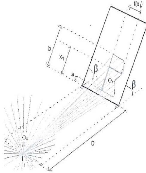
FIGURE 4.3 – Géométrie décrivant la généralisation de l'angle solide.
