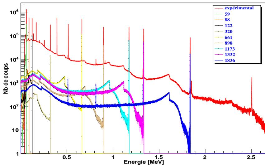
FIGURE 4.15 – Spectre de l'étalon non corrigé pour les effets de sommation (rouge) à comparer avec le spectre simulé (bleu). Les autres spectres représentent les raies de l'étalon simulé par MCNPX séparément pour se substituer aux sources mono-énergétiques.
