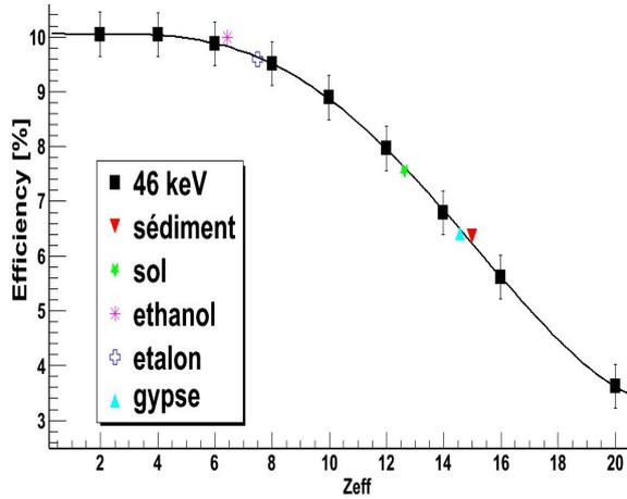
FIGURE 5.12 – Simulation de l'influence de  $Z_{eff}$  sur l'efficacité à 46 keV.
