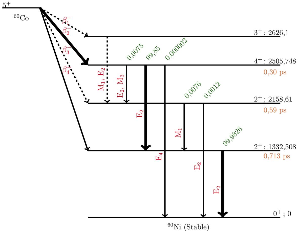
FIGURE 1.2 – Schéma de désintégration du  $^{60}\text{Co}$ .
