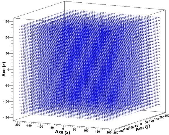
FIGURE 6.6 – Maillage du local simulé de dimensions  $4\text{ m} \times 5\text{ m} \times 2,8\text{ m}$  et des murs de  $20\text{ cm}$ .
