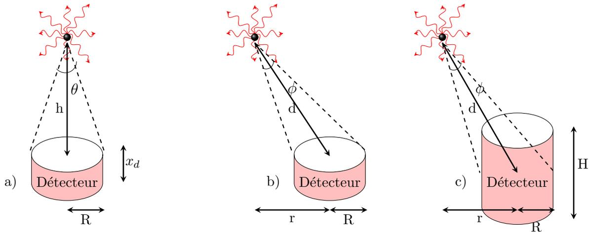
FIGURE 4.4 – Configuration des différents cas d'angle solide.
