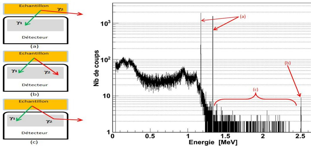
FIGURE 4.2 – Différentes configurations de détection de deux  $\gamma$  émis simultanément par le  $^{60}\text{Co}$ . (a) : pas de coïncidence, (b) : coïncidence entre  $\gamma_1 + \gamma_2$ , avec les énergies totalement absorbées. (c) :  $\gamma_1 + \gamma_2$  Compton ou inversement.
