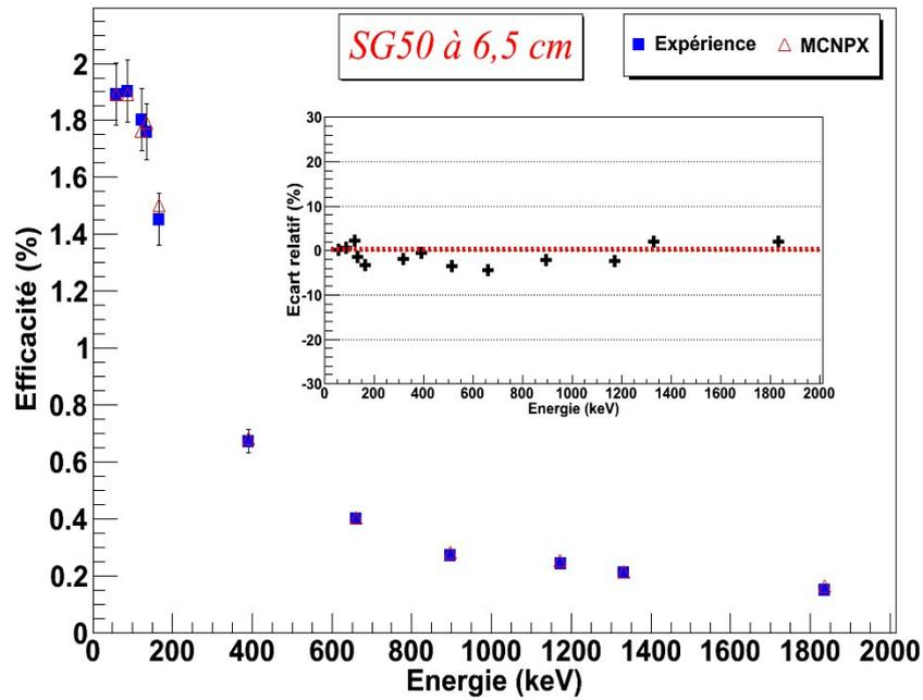
FIGURE 4.22 – Comparaison entre les efficacités expérimentales et simulées pour un SG50 positionnée à 6,5 cm et leurs écarts dus au effets de PS.
