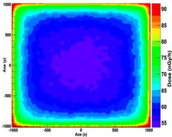
FIGURE 6.10 – Distribution de la dose dans une pièce de  $10 \text{ m} \times 10 \text{ m} \times 10 \text{ m}$ .
