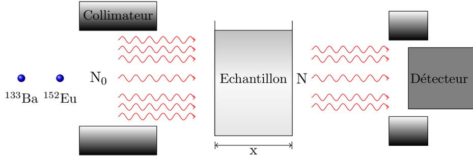
FIGURE 5.1 – Schéma descriptif de la méthode de transmission.
