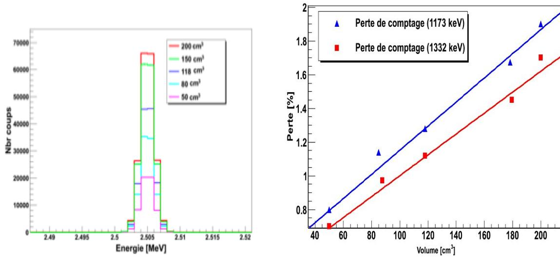
FIGURE 4.6 – Intensité du pic-somme à 2505 keV du  $^{60}\text{Co}$  en fonction de la variation de volume du détecteur.
