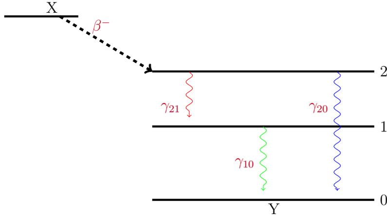
FIGURE 4.11 – Schéma de désexcitation à deux niveaux excités.
