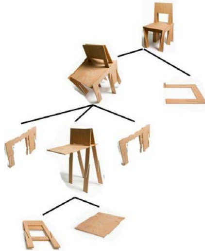
FIGURE C.6 – Représentation composite d'une chaise sous la forme d'une hiérarchie
