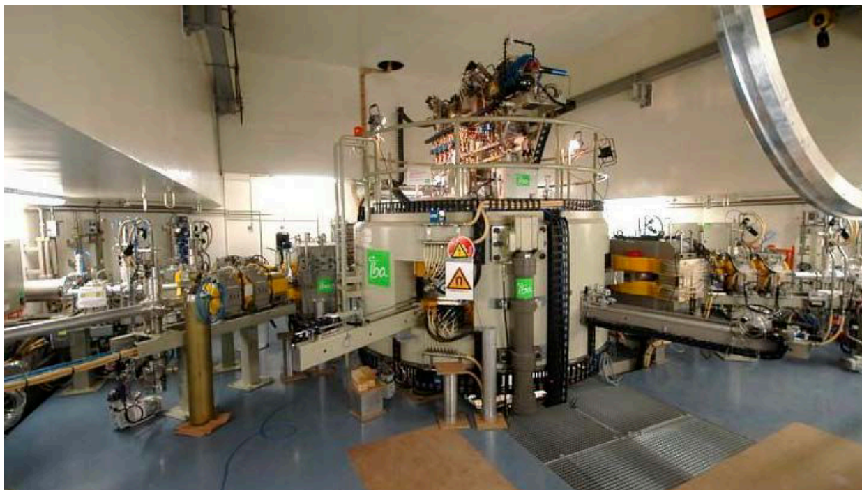
Figure 15 : le cyclotron d'ARRONAX ; son diamètre extérieur est de 4 m et sa hauteur de 3,6 m
