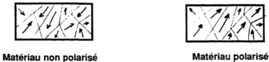
FIGURE A.2: Représentation schématique d'un matériaux polycristallin, avant et après la polarisation
