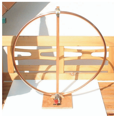
FIGURE 1.2 – Antenne boucle sensible au champ magnétique.
