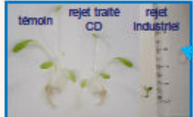
Figure 4 : Rejets de traitement de surface traités par bioadsorption [technique en mode cuvée : 100 mg polymère, 100 mL effluent, 1 h agitation; photométrie et AA four/flamme]
