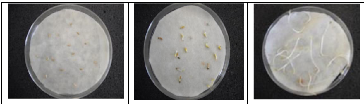
Figure 45 : Suivi d'un test de germination témoin : tests à J0 (à gauche), à J3 (au milieu) et à J7 (à droite).
