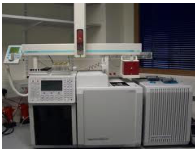
Figure 46 : Illustration de la GC-MS utilisée (Institut PROTMED, Bucarest, Roumanie).
