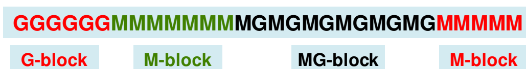
Figure 32 : Structure macromoléculaire d'un acide alginique.
