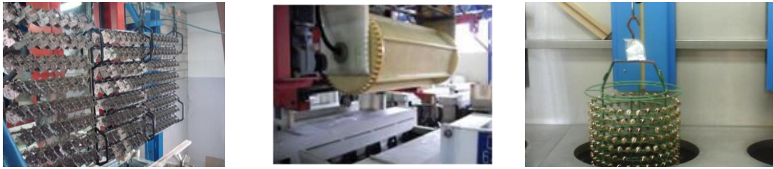
Figure 13 : Photographies illustrant un cadre (à gauche), un tonneau (au milieu) et un panier (à droite).
