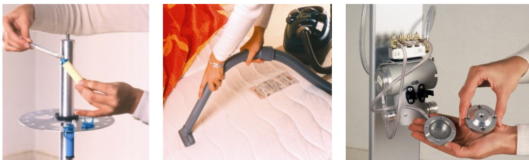
(a) Support adsorbant solide utilisé pour les prélèvements de COV et aldéhydes (b) Prélèvement par aspiration des acariens sur un matelas (c) Appareils de prélèvement des particules
