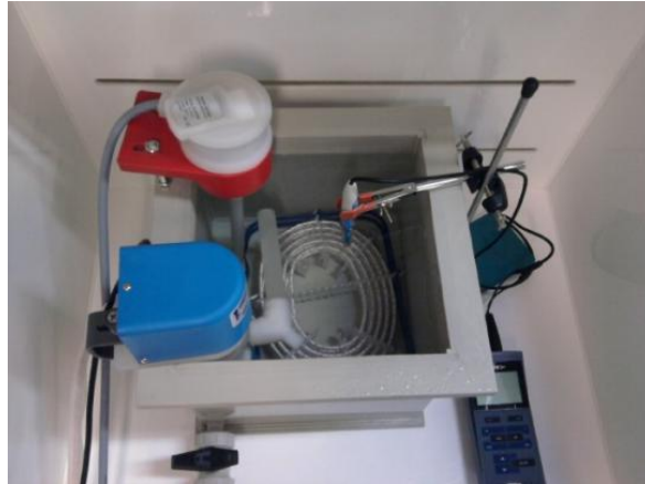
Figure IV.5 : Cuve de traitement sous le capteur frontal
