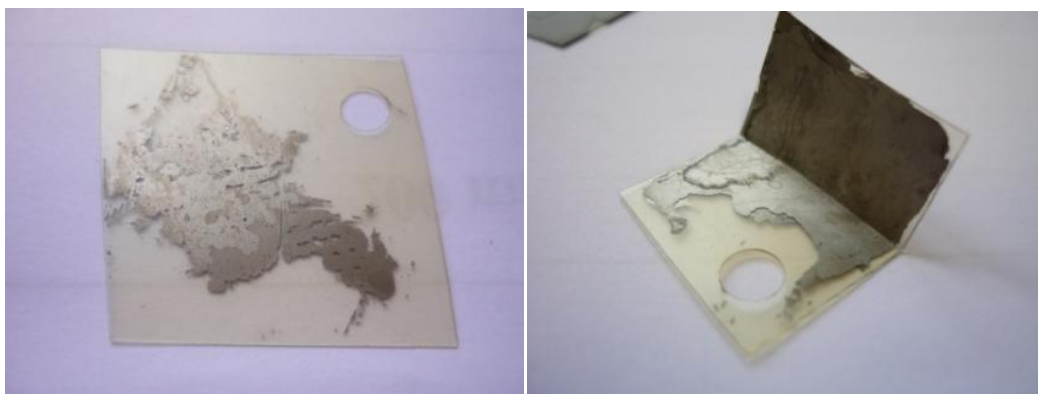
Figure IV.7 : Echantillons métallisés partiellement mais présentant une très bonne adhérence
