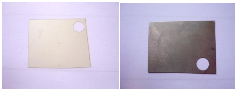
Figure IV.9 : Echantillon d'Ultem témoin puis totalement métallisé
