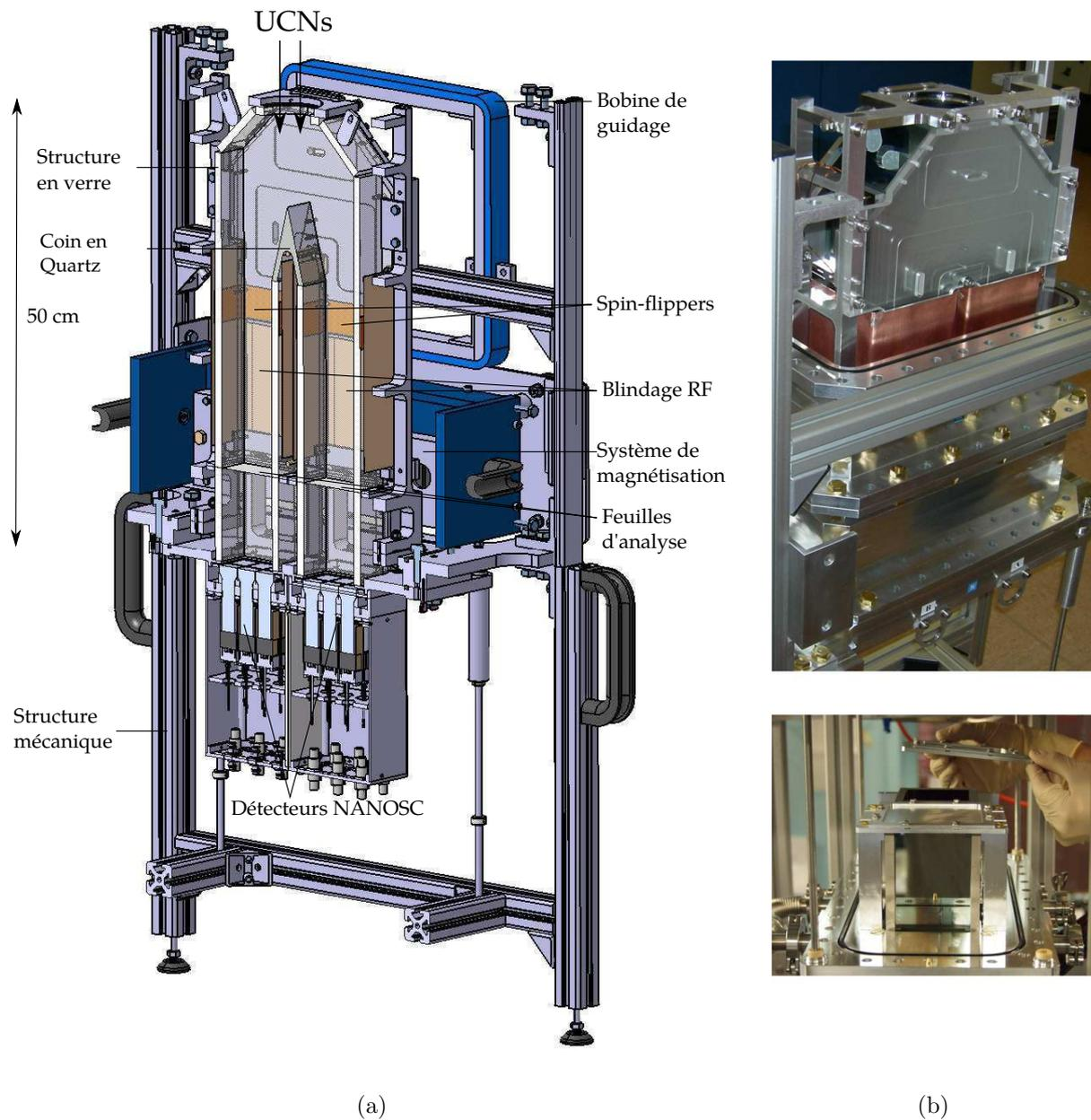
FIGURE 5.1 – A gauche : Vue en coupe d'un dessin mécanique du USSA. En haut à droite : vue ouverte du USSA avec le blindage RF ainsi que le bas de la chambre à vide visibles. En bas à droite : installation des feuilles d'analyse du USSA.
