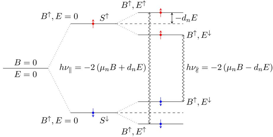
FIGURE 2.1 – Schéma de séparation des niveaux d'énergie d'un neutron possédant un EDM non nul dans des champs électrique et magnétique. Les indices  $\parallel$  et  $\nparallel$  correspondent respectivement à des configurations de champ électrique et magnétique parallèles et anti-parallèles.
