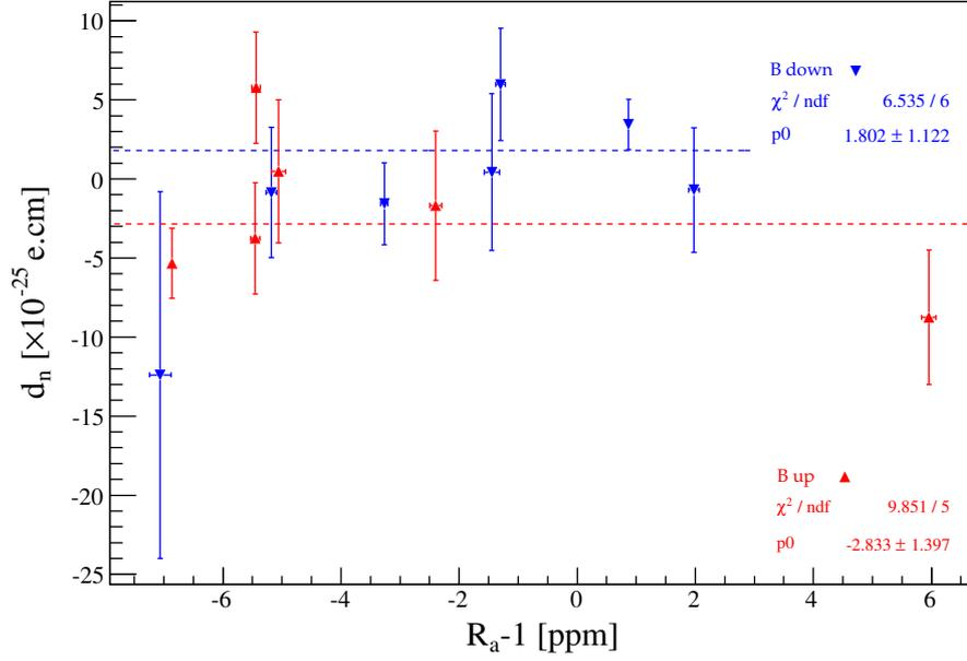
FIGURE 6.2 – Ajustement des données nEDM 2013 sans correction de l’effet de phase géométrique. Les configurations avec  $B_0$  up sont représentées par les triangles rouges pointant vers le haut. Les configurations avec  $B_0$  down sont représentées par les triangles bleus pointant vers le bas.
