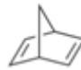
FIGURE 1.11 – Représentation de la molécule de BCDH, porogène utilisé dans la fabrication du SiOCH poreux.
