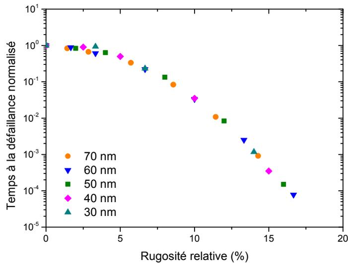
FIGURE 5.12 – Évolution du temps caractéristique à la défaillance en fonction de la rugosité relative de la ligne pour différents espacements intermétalliques. Simulation réalisée avec  $E=4$  MV/cm,  $\beta=1.2$  et une longueur de structure de 100 mètres.
