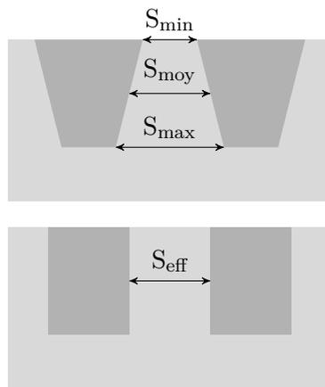
FIGURE 5.3 – Représentation d'une ligne trapézoïdale et de ses dimensions caractéristiques et association à une ligne rectangulaire équivalente d'espace diélectrique  $S_{\text{eff}}$ .
