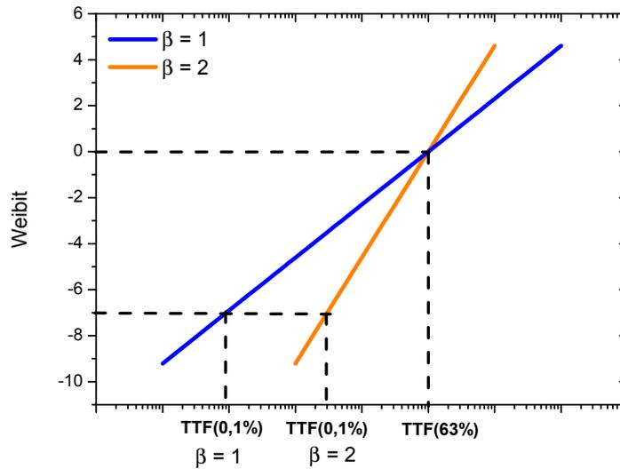
FIGURE 1.26 – Illustration de l'importance de la pente de Weibull sur l'extrapolation vers les faibles taux de défaillance.
