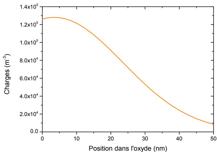
FIGURE 3.19 – Distribution de charges piégées dans le diélectrique. La densité volumique de charges piégées est de  $8 \cdot 10^{23}$  charges/m<sup>3</sup>.
