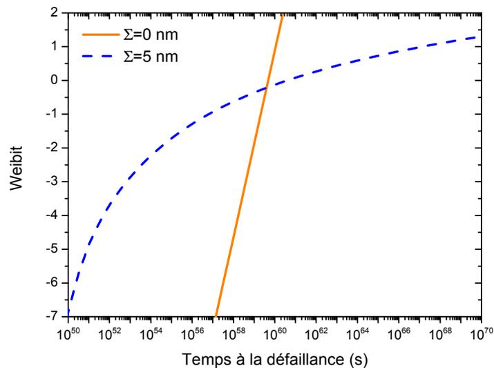
FIGURE 5.18 – Impact de la variation de l'espaceur diélectrique moyen à l'échelle du wafer sur la distribution des temps à la défaillance. Simulation réalisée à 1.125 volts, avec  $\beta=1.2$  et  $\sigma=3$  nm pour une longueur de structure de 100 mètres.
