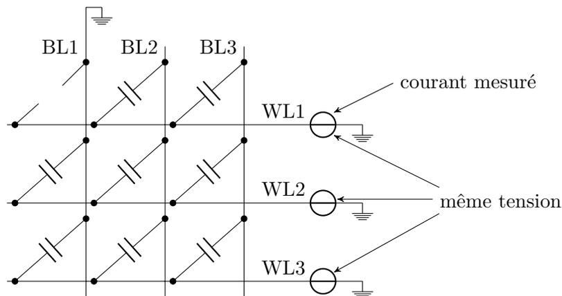
FIGURE 1.19 – Méthodologie permettant la mesure de la structure supérieure gauche entre la “Bit-line” 1 et la “word-line” 1.
