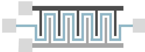
FIGURE 1.17 – Les structures de tests peignes serpents
