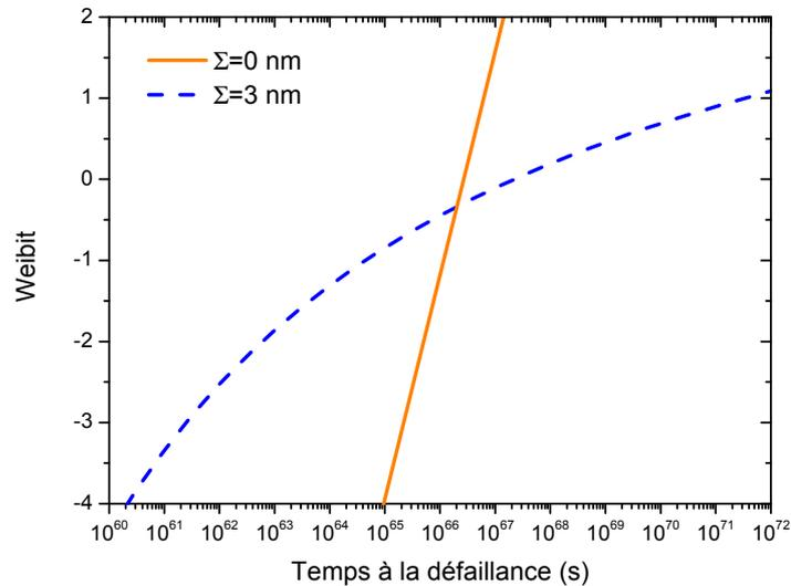
FIGURE 5.17 – Impact de la variation de l'espaceur diélectrique moyen à l'échelle du wafer sur la distribution des temps à la défaillance. Simulation réalisée avec  $E=0.2$  MV/cm,  $\beta=1.2$  et  $\sigma=3$  nm pour une longueur de structure de 100 mètres.
