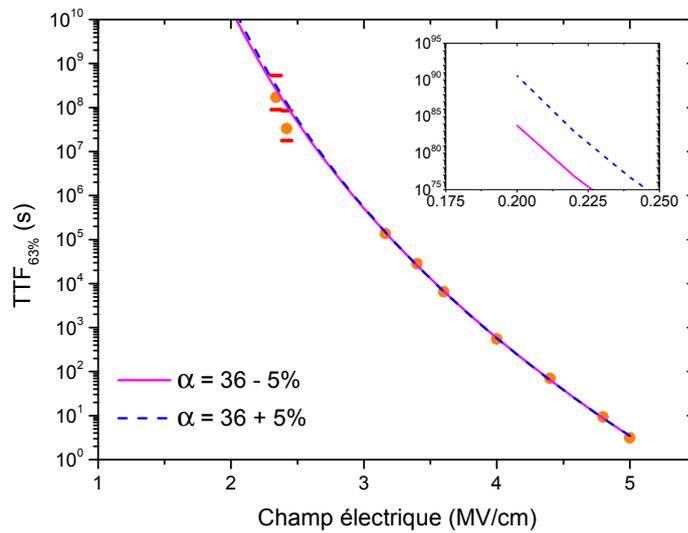
FIGURE 4.11 – Durée de vie du diélectrique en fonction du champ électrique calculée avec le modèle LE pour deux paramètres  $\alpha$  différents de 10%. La différence de durée de vie à la tension d’opération est de sept décades.
