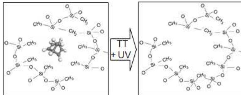
FIGURE 1.12 – Représentation du diélectrique SiOCH poreux avant et après le recuit thermique.
