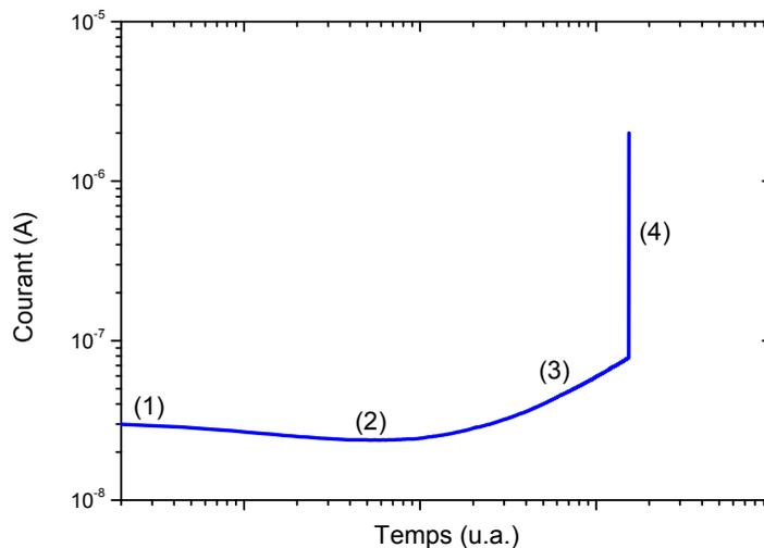
FIGURE 2.1 – Évolution caractéristique du courant de fuite dans un diélectrique soumis à une contrainte électrique
