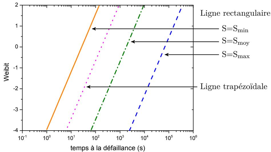
FIGURE 5.4 – Impact de la forme trapézoïdale de la ligne sur le temps à la défaillance comparé à une ligne rectangulaire d’espacement diélectrique minimal, médian et maximal. (Simulation réalisée à 20 volts avec  $\beta=1,2$  et  $S_{\min}=50$  nm).
