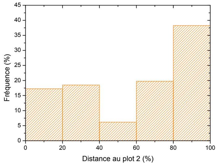
FIGURE 2.24 – Probabilité de claquage en fonction de la distance au plot 2 lorsque la structure est stressée par le plot 3. La distance exprimée est une distance relative à la longueur totale du serpent.
