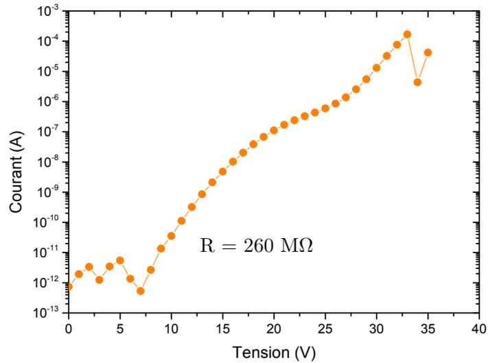
FIGURE 3.24 – Caractéristique I-V d'un diélectrique low- $\kappa$  avant claquage. La résistance avant claquage peut être estimée à  $260 \text{ M}\Omega$  pour des tensions de 10 à 20 volts. [S=70 nm, W=70 nm, L=3 cm, T=25°C]
