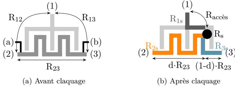
FIGURE 2.20 – Description de la structure peignes–serpentin utilisée pour localiser le point de claquage. La résistance du spot de claquage est notée  $R_s$  et la somme de la résistance du spot et de l’amenée de courant entre le plot (1) et le spot est notée  $R_{\text{accès}}$
