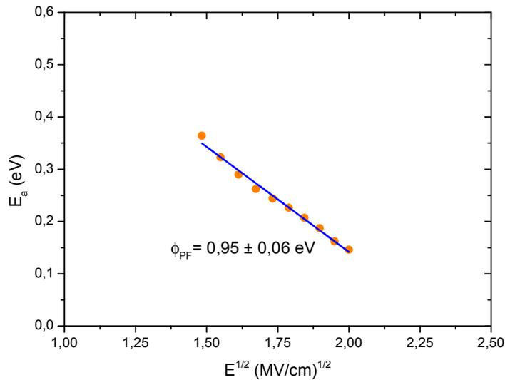
FIGURE 2.11 – Énergie d'activation en fonction de la racine carrée du champ électrique appliqué. [S=50 nm, W=50 nm, L=2 mm]
