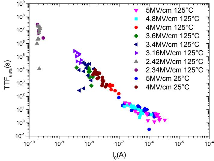
FIGURE 3.14 – Évolution du temps à la défaillance en fonction du courant de fuite initial pour différents champs électriques à 25 et 125°C. [S=45 nm, W=45 nm, L=2 mm]
