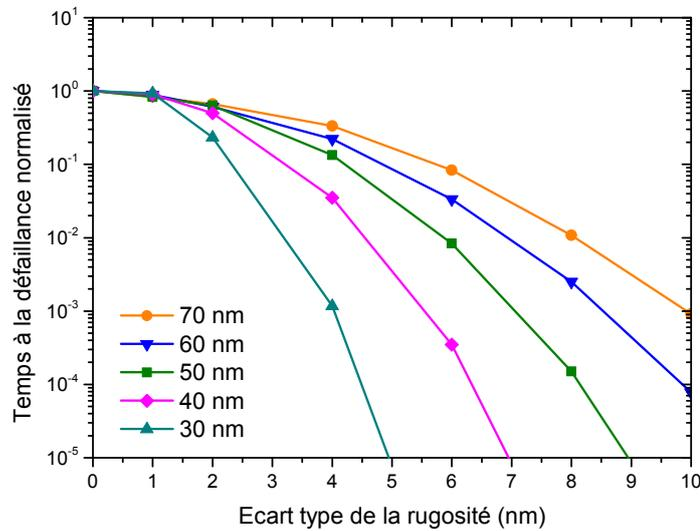
FIGURE 5.11 – Évolution du temps caractéristique à la défaillance en fonction de l'écart type de la rugosité de la ligne pour différents espacements intermétalliques. Simulation réalisée avec  $E=4$  MV/cm,  $\beta=1.2$  et une longueur de structure de 100 mètres.
