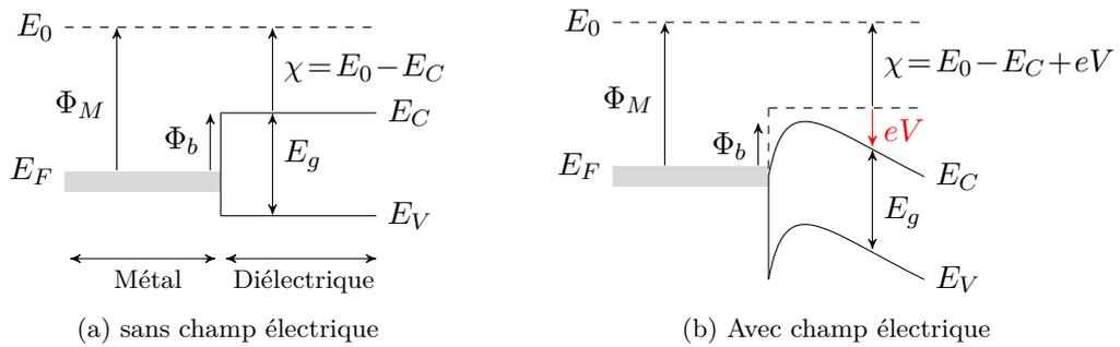
FIGURE 2.2 – Niveaux d'énergie à l'interface métal-diélectrique
