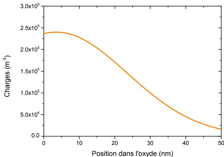
FIGURE 4.20 – Distribution de charges piégées dans le diélectrique. La densité volumique de charges piégées est de  $1,2 \cdot 10^{24} \text{ charges/m}^3$ .
