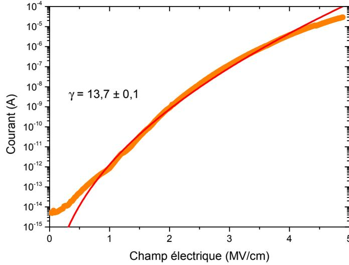
FIGURE 4.7 – Comparaison entre une caractéristique I–V et le modèle de conduction de Poole-Frenkel. Une valeur de  $13,7 \pm 0,1$   $(\text{cm/MV})^{0.5}$  est extraite de la modélisation pour  $\gamma$ . [S=50 nm, W=50 nm, L=2 mm, T=125°C]
