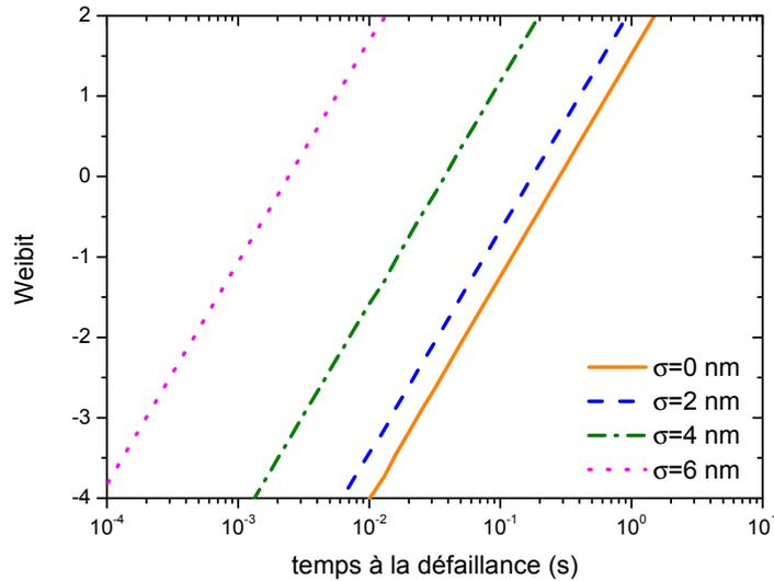
FIGURE 5.10 – Simulation de l'évolution des temps à la défaillance en fonction de l'écart type de la rugosité de la ligne. Simulation réalisée avec  $E=4$  MV/cm,  $\beta=1.2$  et un espacement nominal de 50 nm pour une longueur de structure de 100 mètres.
