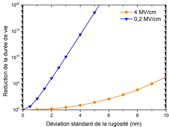
FIGURE 5.13 – Diminution de la durée de vie en fonction de l'écart type de la rugosité à la tension de test et à la tension d'opération. Simulation réalisée avec  $\beta=1.2$  et un espacement nominal de 50 nm pour une longueur de structure de 100 mètres.
