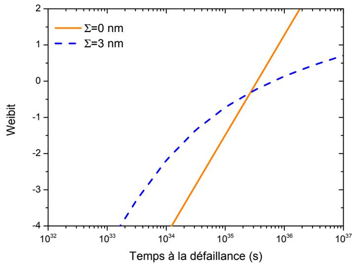
FIGURE 5.16 – Impact de la variation de l’espacement diélectrique moyen à l’échelle du wafer sur la distribution des temps à la défaillance. Simulation réalisée avec  $E=0.4$  MV/cm,  $\beta=1.2$  et  $\sigma=3$  nm pour une longueur de structure de 100 mètres.
