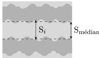
FIGURE 5.7 – Représentation schématique de la rugosité de la ligne et de son importance sur l'espacement minimal entre deux lignes de métal.
