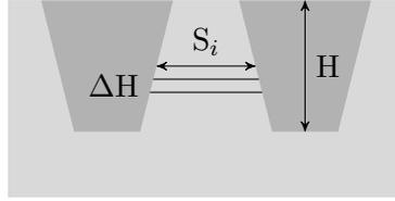
FIGURE 5.2 – Le diélectrique est découpé en  $N$  éléments parallèles entre eux de hauteur  $\Delta H$  et de section  $S_i$ .
