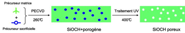
FIGURE 1.10 – Méthodologie de réalisation d'un diélectrique poreux [Vilmay2010].
