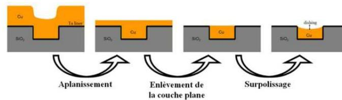
FIGURE 1.13 – Schéma de principe des étapes de la CMP [Bernard2006]
