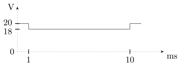
FIGURE 3.7 – Représentation du signal de stress utilisé pour l'étude de l'additivité de l'endommagement. La période est de 10 millisecondes et le temps de pulse à 20 volts de 1 milliseconde.
