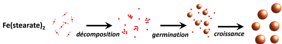
Figure 6 : Représentation schématique du procédé de synthèse de NPs par décomposition thermique.
