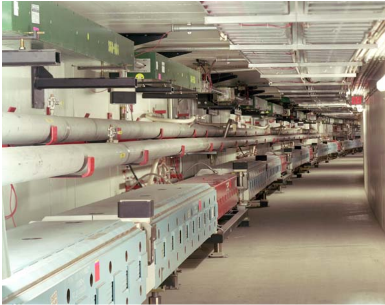
Figure 4.4: Vue de la galerie de l'injecteur principal du TeVatron (aimants du bas en bleu et rouge) et du recycleur (aimants du haut en vert)
