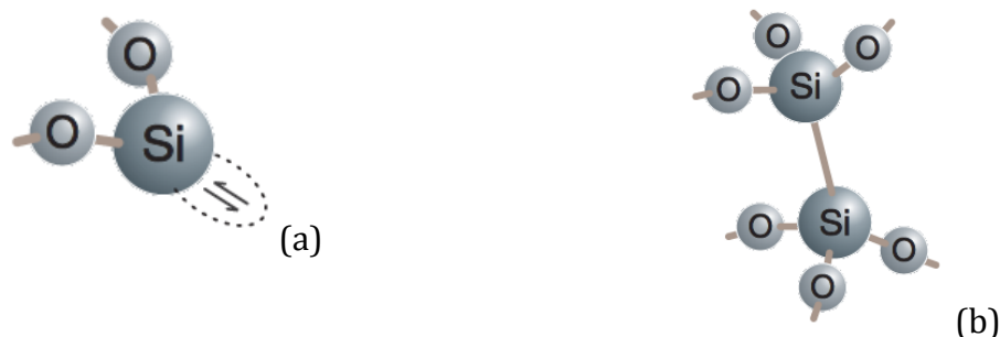
Figure 1.1.3 : Défauts déficitaires en oxygène diamagnétiques, SiODC(I) à gauche (a) et SiODC(II) à droite (b) [11]
