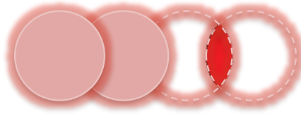
Figure 3.2.1 : Chevauchement (rouge vif) des impulsions (rouge pâle) lors du déplacement rectiligne du faisceau laser
