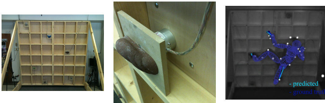
FIGURE 3.4 – Le mur d'escalade instrumenté, un détail d'une prise, la prédiction des forces de contacts.
