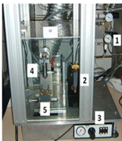
Fig. 2-7: a) Schéma, b) Photographie de principe du dispositif de dépôt par pulvérisation
