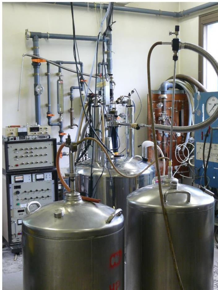
Figure 103 : Vue d'ensemble du spectromètre RMN.
