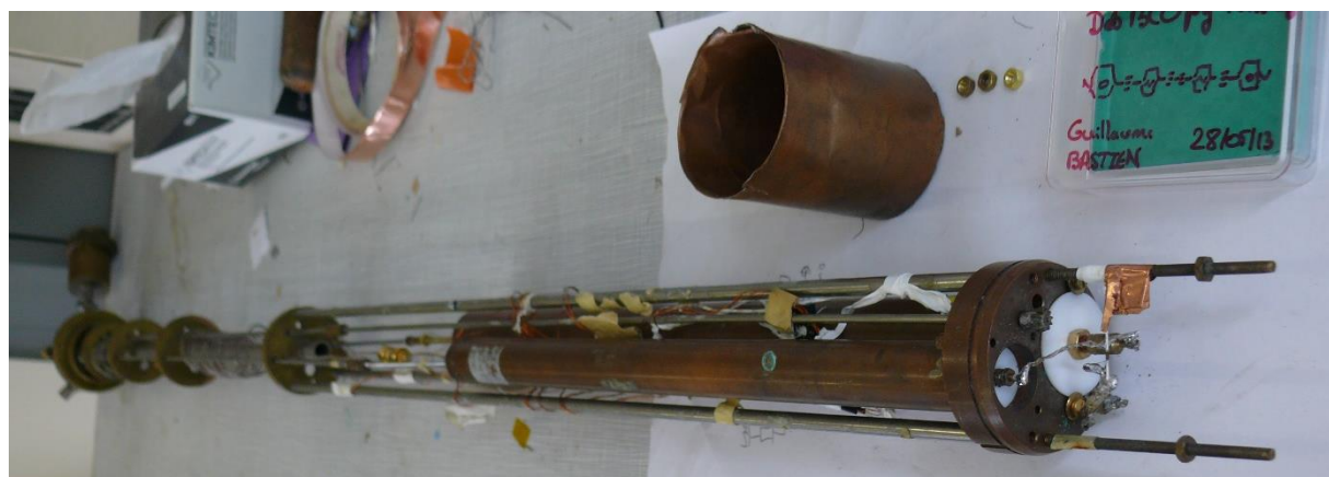
Figure 102 : Vue d'ensemble de la sonde RMN.
