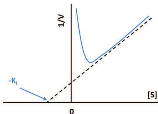
**Figure 28.** Représentation de  $1/V$  en fonction de  $[S]$  pour une enzyme michaelienne inhibée par un excès de substrat. La droite obtenue coupe l'axe  $[S]$  en  $-K_i$  ou  $K_i$  est la constante de dissociation du complexe enzyme-substrat.
