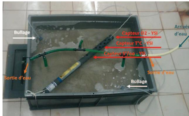
**Figure 36.** Dispositif expérimental mis en place pour la recherche d'un cycle endogène sur l'activité de 3 enzymes d'intérêt : la phénoloxydase, la superoxyde dismutase et la catalase chez la palourde japonaise. Les 2 systèmes de bullages sont disposés à chaque extrémité du bac et les arrivées en eau de mer filtrée sont réparties de façon homogène à la surface du bac. La sonde (YSI OMS 600 V2) est immergée à la surface du bac.
