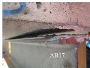
Rupture de AB17 par cisaillement du béton
