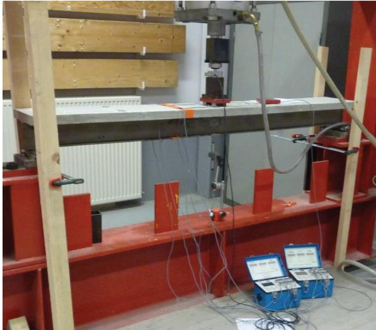
Figure 5.90 : Diapositif de l'essai de fluage
