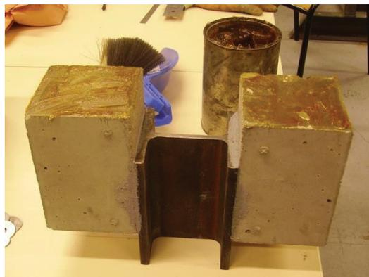
Figure 3.48 : Graissage de la série PO5
