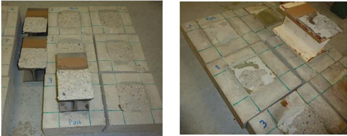
Figure 3.57 : Epruvettes rompues non vieilles et vieilles
