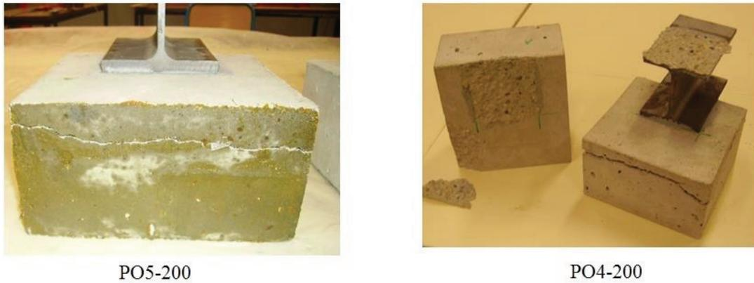
**Figure 3.52 : Epreuves des séries PO4 et PO5 rompues**
