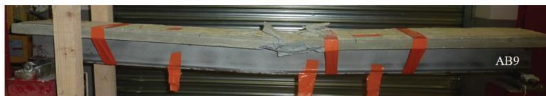
Rupture de AB9 et AB16 par écrasement du béton
