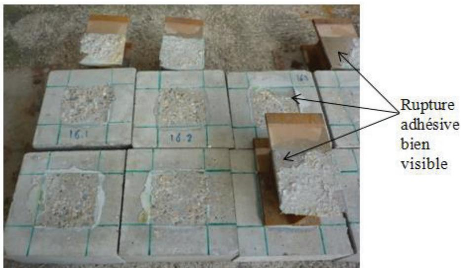
Figure 3.56 : Eprouvettes de la série PO16 rompues
