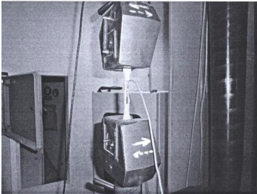
Figure 2.16 : Montage de l'essai de traction réalisé sur éprouvettes haltère
